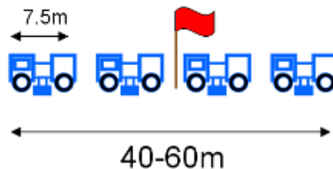
Figura 2.p: Schema Energizzazione a Vibratori
