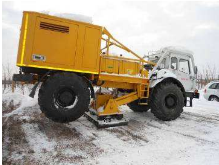
Figura 2.o: Vibratore durante le Fasi di Energizzazione
