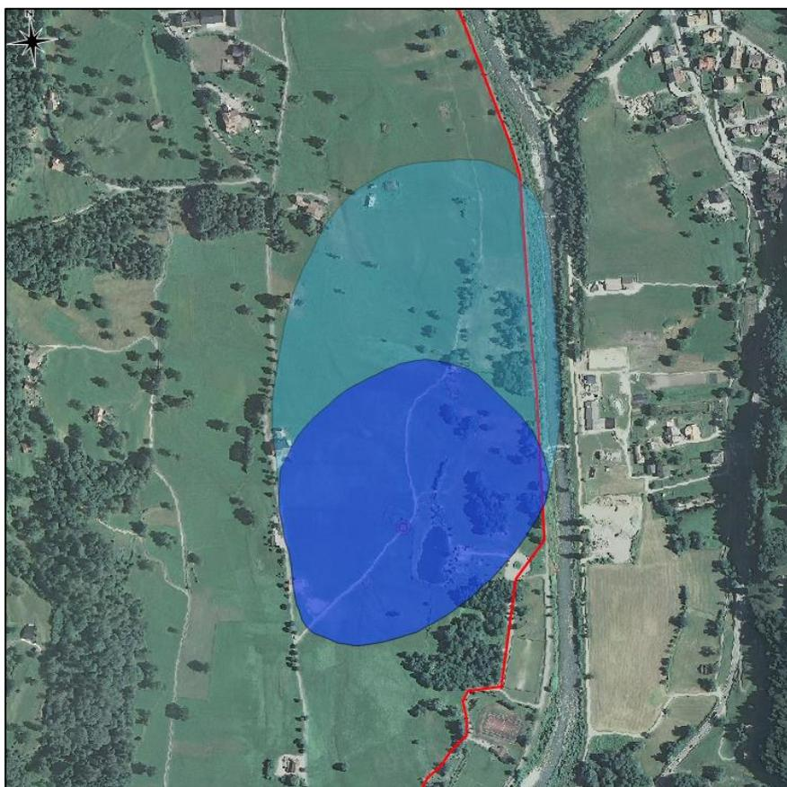
Figura 2.38 Intersezione del tracciato con l'area di rispetto idrogeologico di una sorgente tra gli abitati di Giustino e Caderzone.
