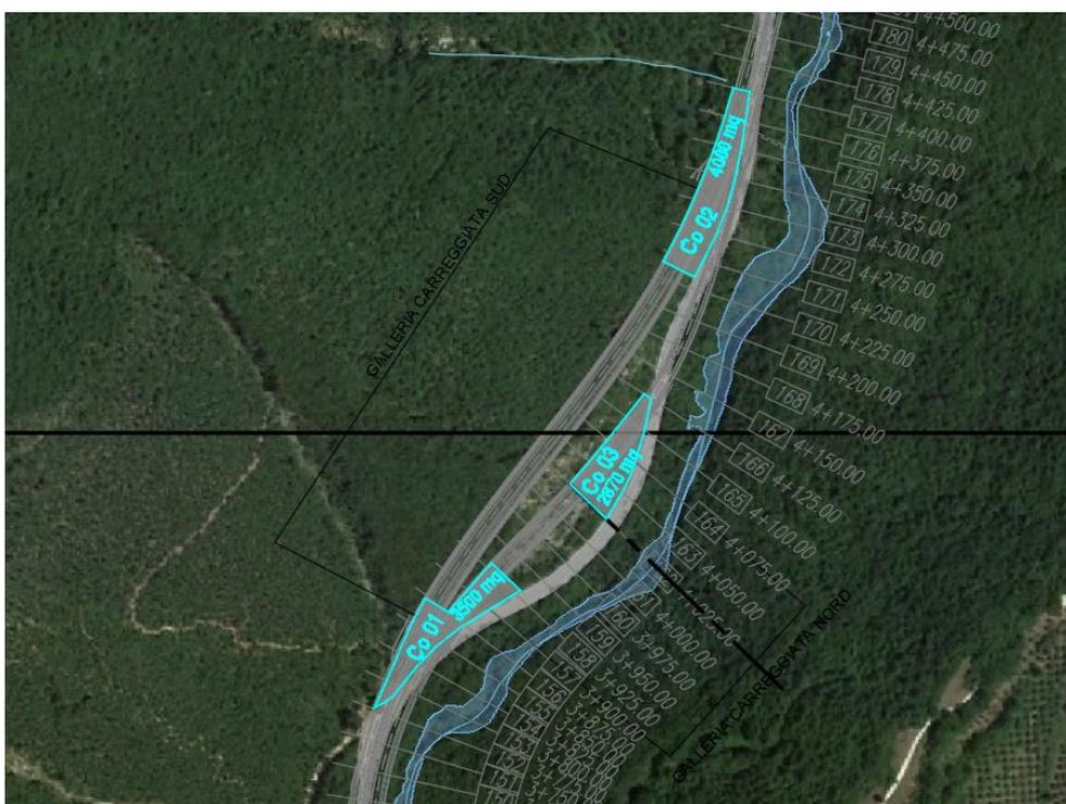
Figura 27 – Ubicazione cantieri d'opera Co01, Co02, Co03 in corrispondenza delle gallerie in progetto
