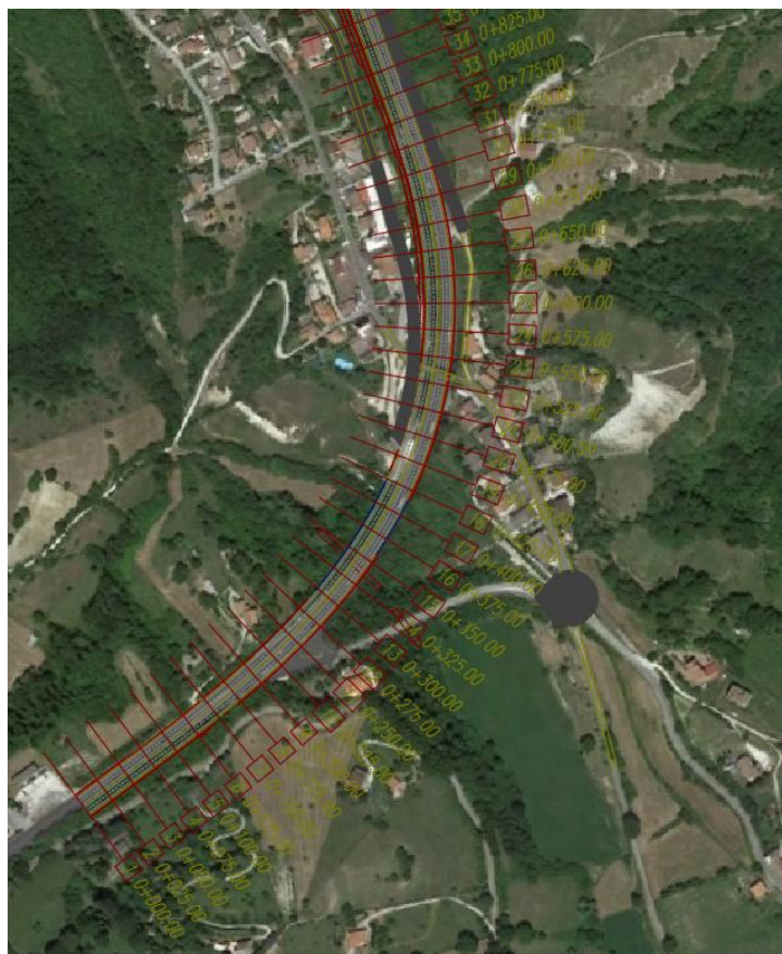
Figura 2 – Tracciato di progetto dal km 64+000 al km 64+800
