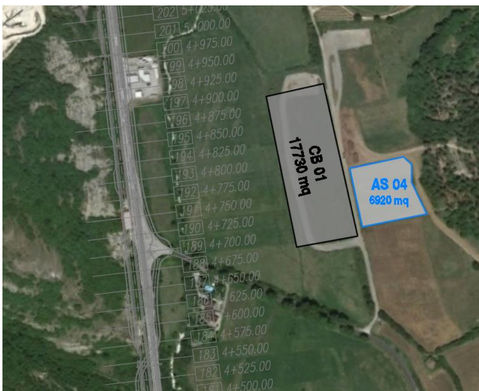
Figura 24 – Ubicazione cantiere base CB01 e area stoccaggio AS04 in prossimità dell'intersezione con la SP34
