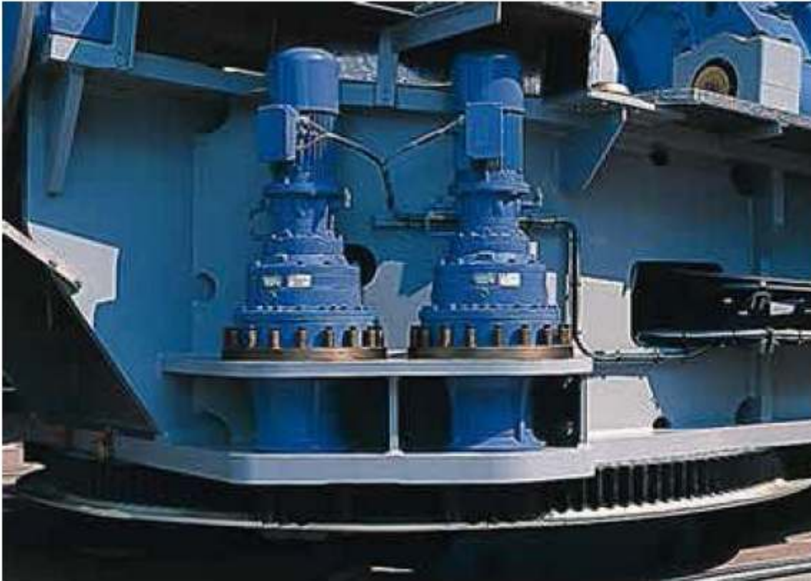
Figura 12.3. – Particolare Idraulico di Imbardata.
