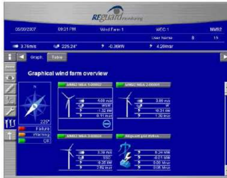
Figura 11.3. – SCADA: visualizzazione stato del Parco Eolico.
