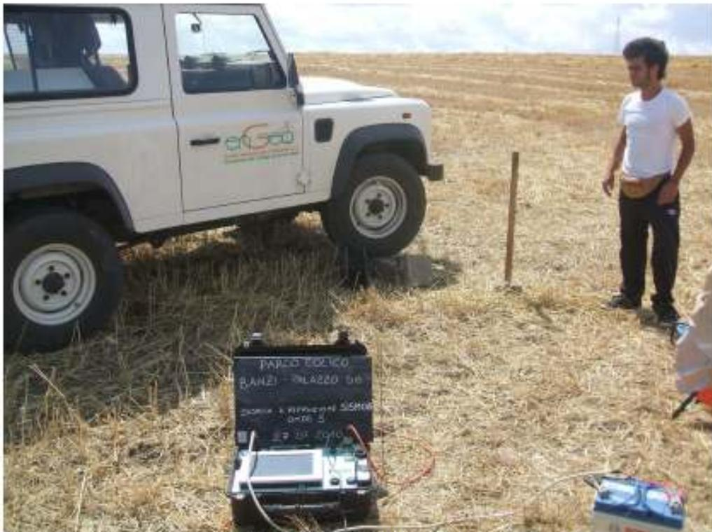
Stendimento sismico Sism06 in onde S
