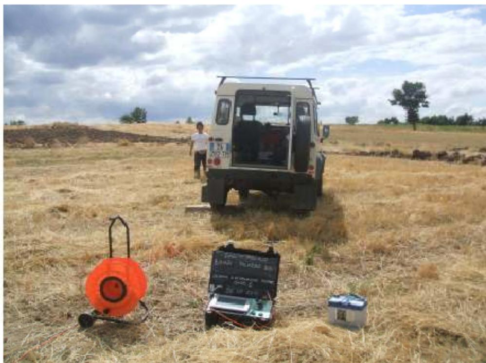
Stendimento sismico Sism01 in onde S
