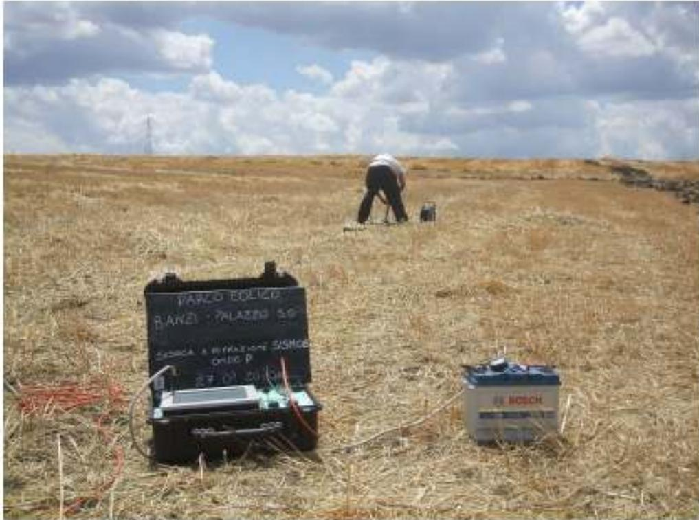
Stendimento sismico Sism06 in onde P
