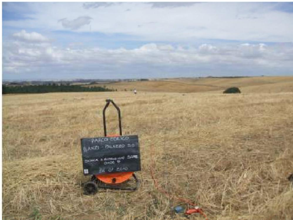
Stendimento sismico Sism01 in onde P
