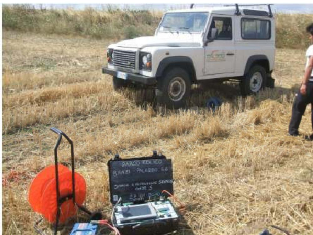
Stendimento sismico Sism05 in onde S
