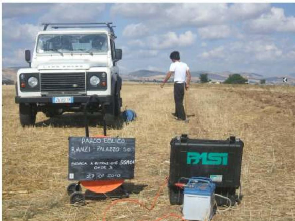
Stendimento sismico Sism04 in onde S
