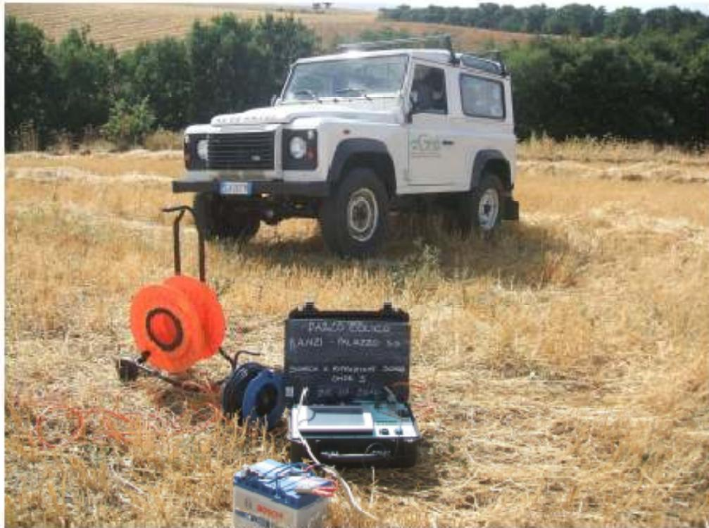
**Stendimento sismico Sism02 in onde**
