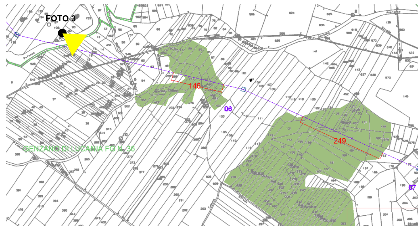
Figura 37: Individuazione delle aree boscate con cui la linea interferisce solo in sorvolo , non c'è impatto diretto sul bene vincolato.
