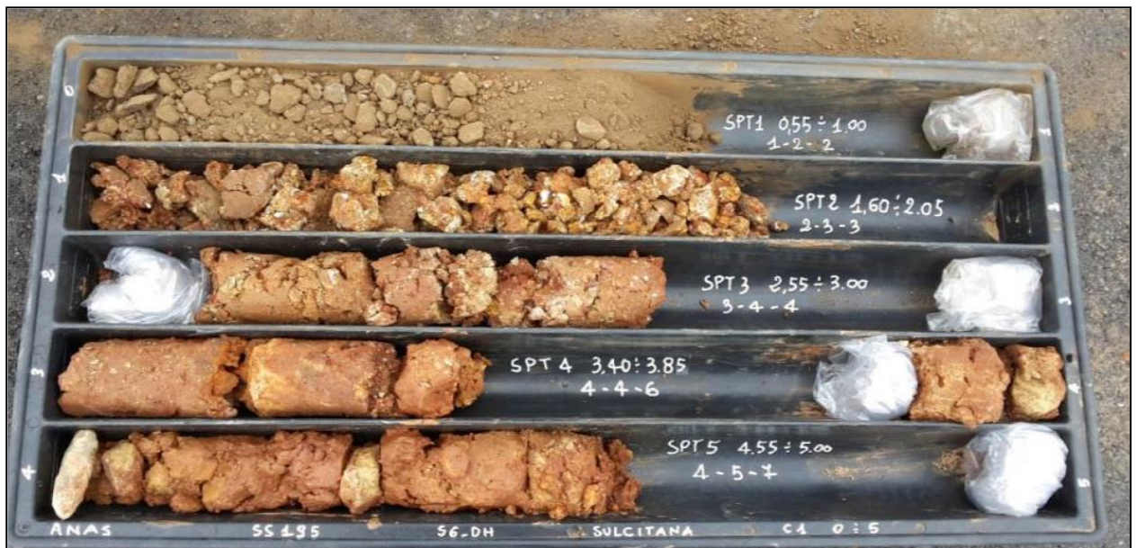
Foto 2 - Terre rimaneggiati estratti dal sondaggio S06_DH, intervallo di profondità 0,06÷9,00 m.
