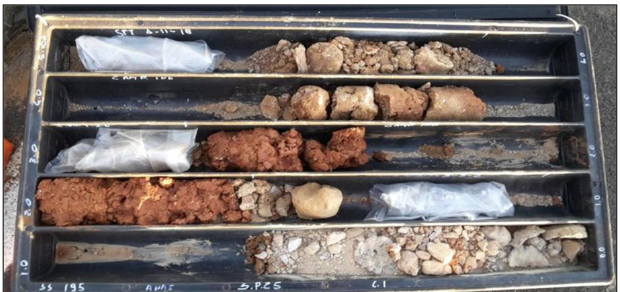
Foto 1 - Materiali di riporto estratti dal sondaggio S05_PZ, intervallo di profondità 0,05÷5,00 m.
