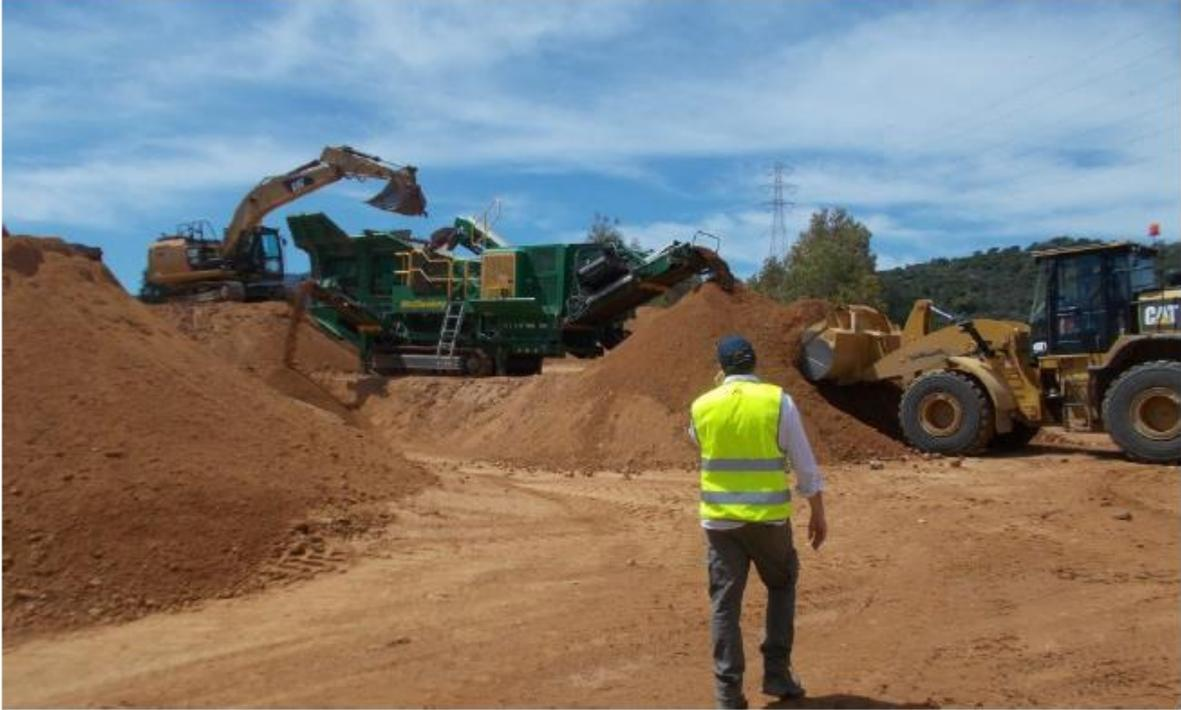
*Figura 3 – Mezzi operativi utilizzati nelle attività dell'impianto di frantumazione – vagliatura*
