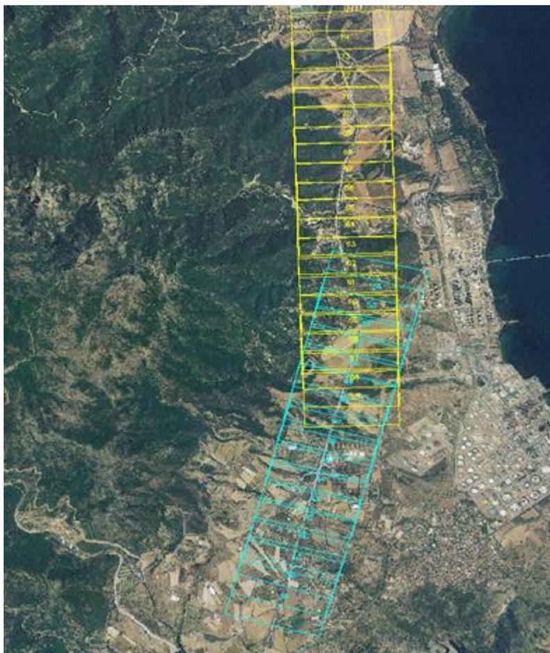
La camera da presa utilizzata per l'acquisizione delle immagini è stata la **Vexcel UltraCam Osprey Mark 3 premium**. Questa camera possiede 8 obiettivi: 3 per l'acquisizione delle immagini in RGB, 1 per il NIR
