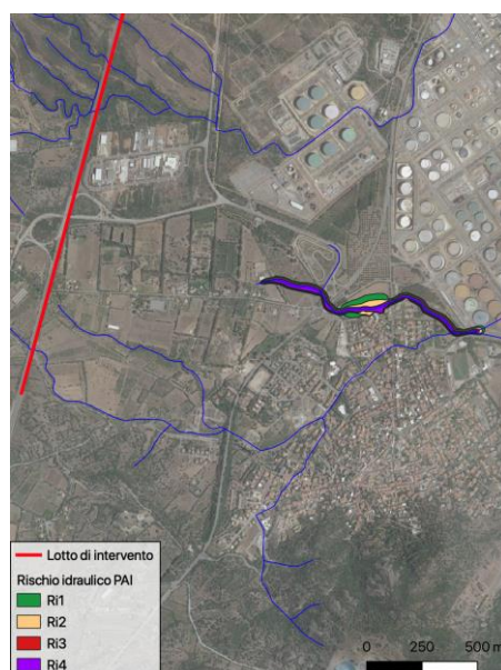
Figura 12 – Aree a rischio idraulico mappate dal PAI in corrispondenza al centro abitato di Sarroch.
