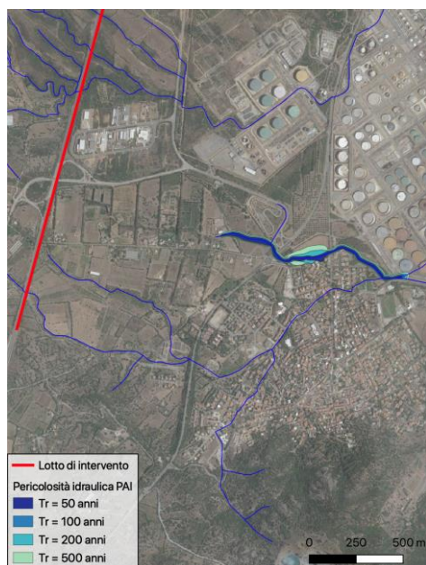
Figura 11 – Aree a pericolosità idraulica mappate dal PAI in corrispondenza al centro abitato di Sarroch.
