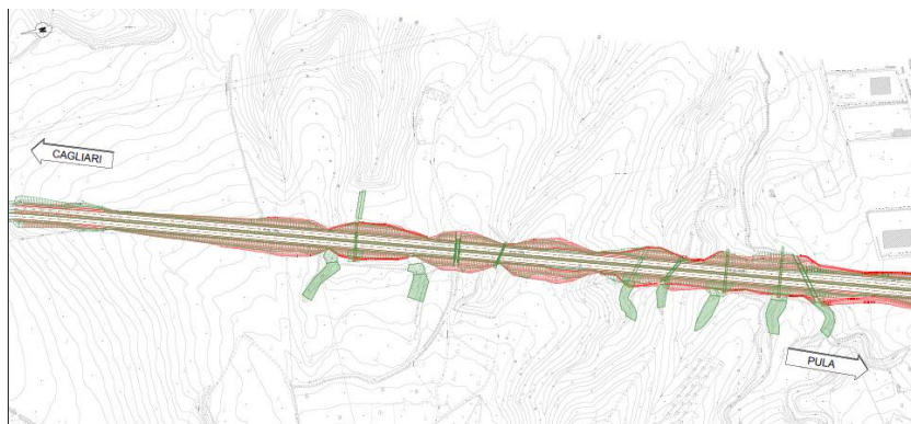
Figura 26- Sovrapposto planimetrico (parte 1) Progetto Definitivo 2007 (in verde) e progetto definitivo oggetto di pronuncia compatibilità ambientale
