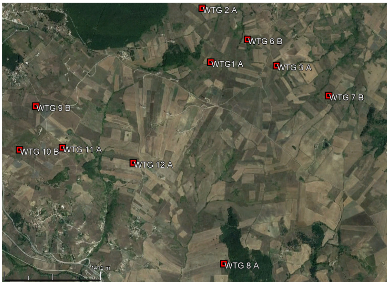
Figura 21 Lay-out ottimizzato (10WTG V136) con indicazione tipo di torre (A/B)
