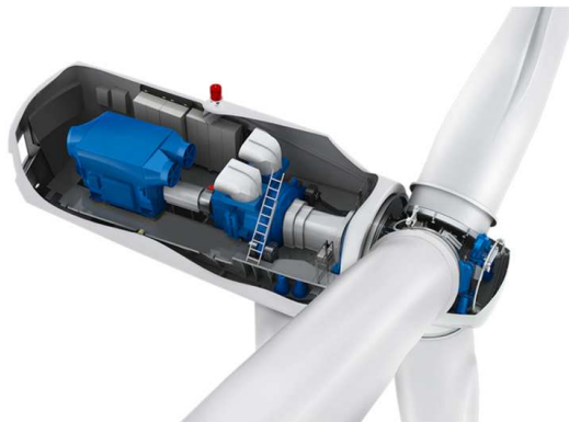
Figura 2. Vestas. Disposizione dei componenti in navicella
