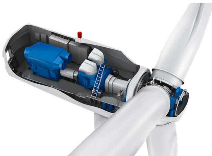
Figura 2. Vestas V136. Disposizione dei componenti in navicella
