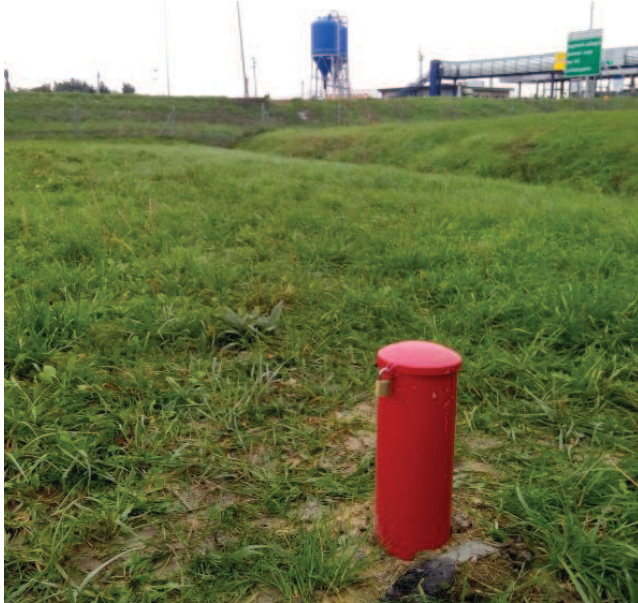
In foto: piezometro in P-S8
