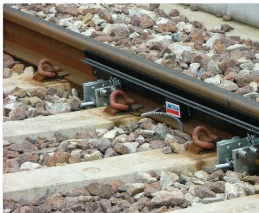
Lubrificatore P.A.L. Italia (Foto: P.A.L. Italia; 2012)
