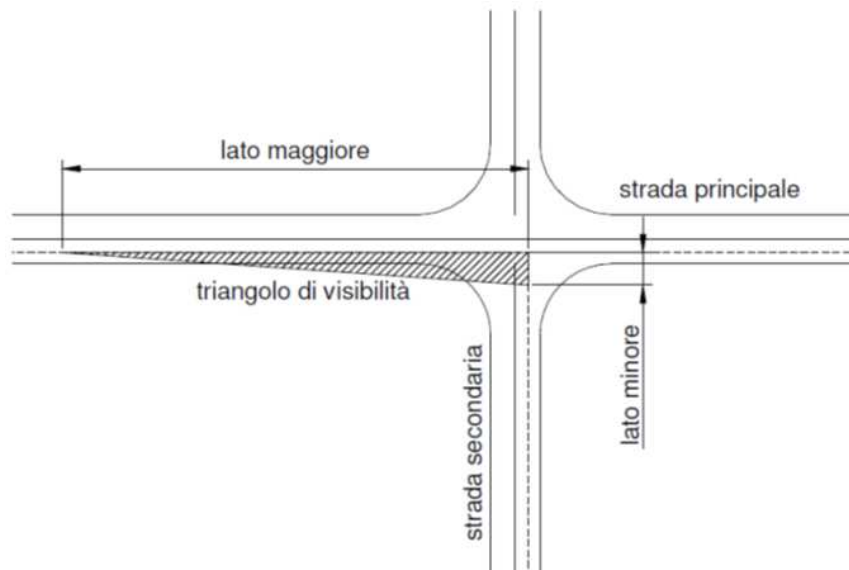
Schema triangoli di visibilità secondo D.M. 19/04/2006
