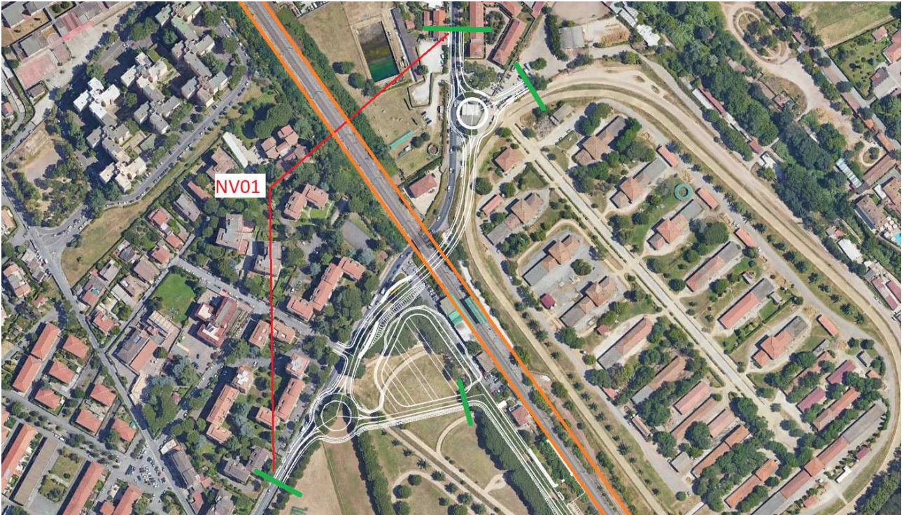
NV01 - Adeguamento di via delle Capannelle (le linee in verde rappresentano i limiti dell'intervento)
