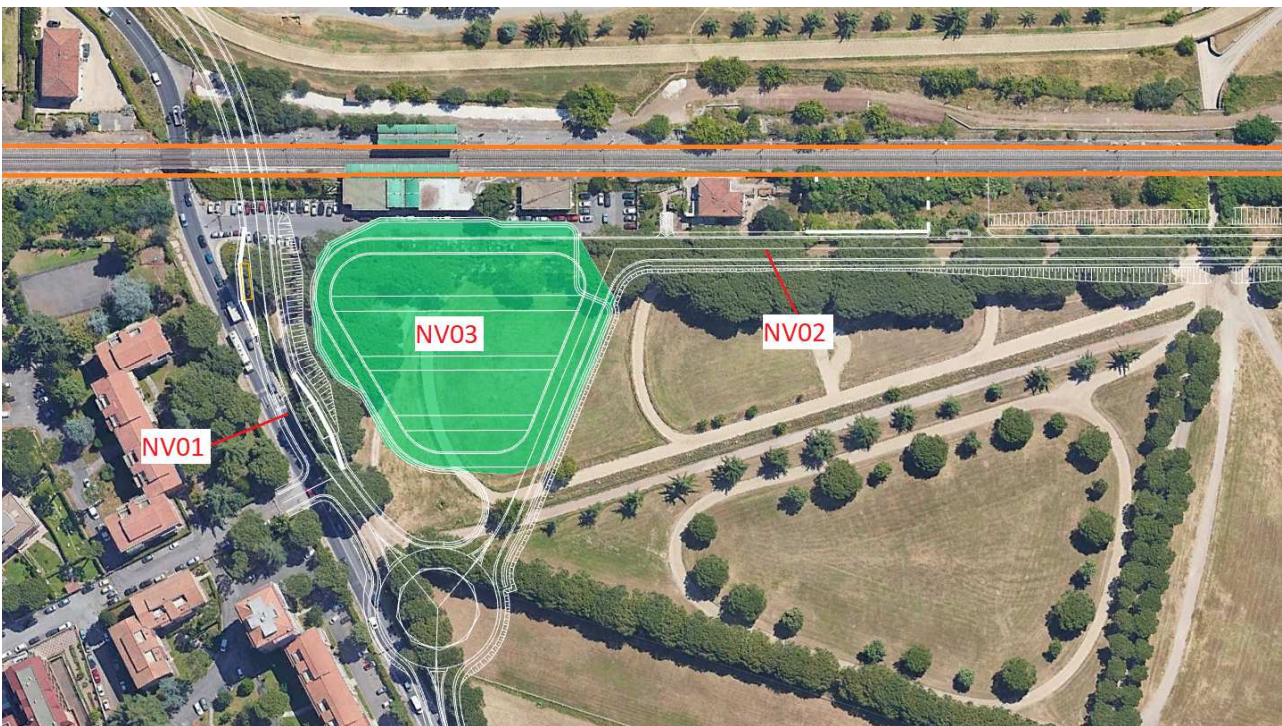
Planimetria su ortofoto di NV03, l'area in verde circoscrive i limiti dell'intervento di NV03 mentre le linee in arancione rappresentano l'area della linea ferroviaria oggetto del quadruplicamento
