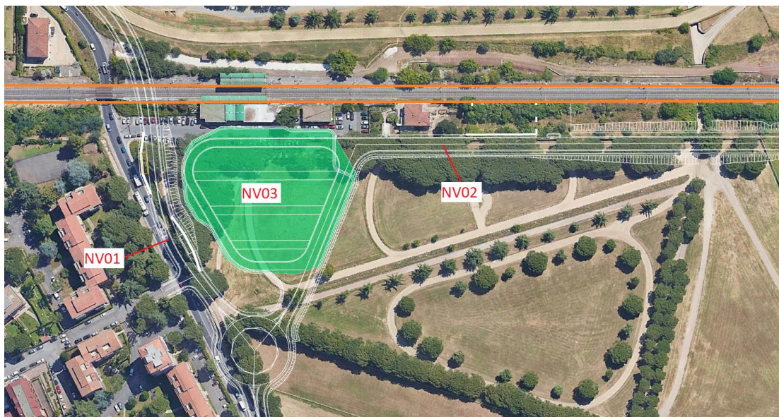
Figura 33 - Planimetria su ortofoto di NV03, l'area in verde circoscrive i limiti dell'intervento di NV03 mentre le linee in arancione rappresentano l'area della linea ferroviaria oggetto del quadruplicamento
