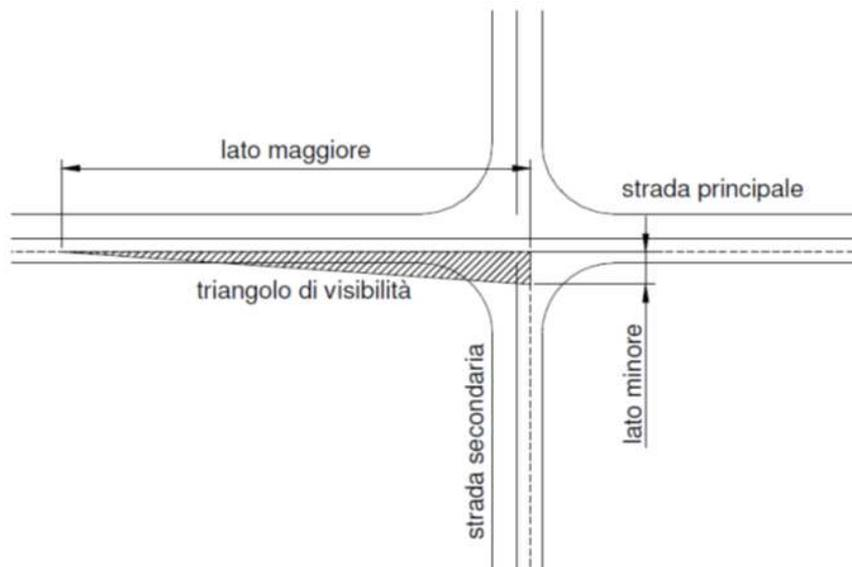
Schema triangoli di visibilità secondo D.M. 19/04/2006
