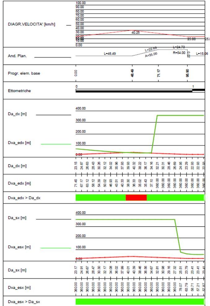
*Diagramma delle visibilità NV02D*
