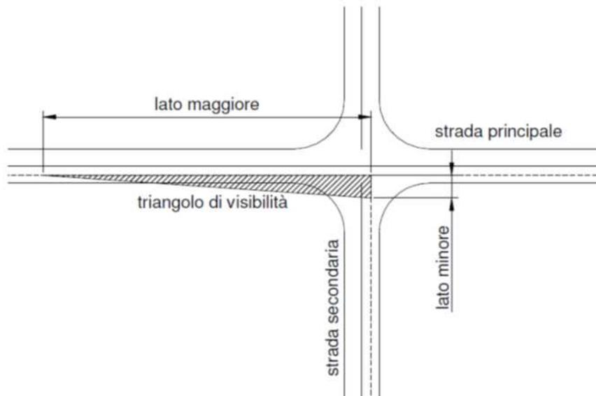
Schema triangoli di visibilità secondo D.M. 19/04/2006
