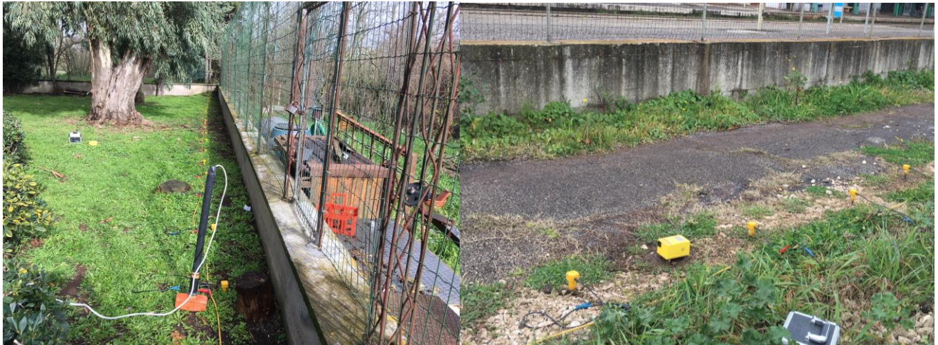
Figura 2: Strumentazione impiegata per le prove di superficie mediante metodologia MASW (a sinistra) e HVSR (a destra).
