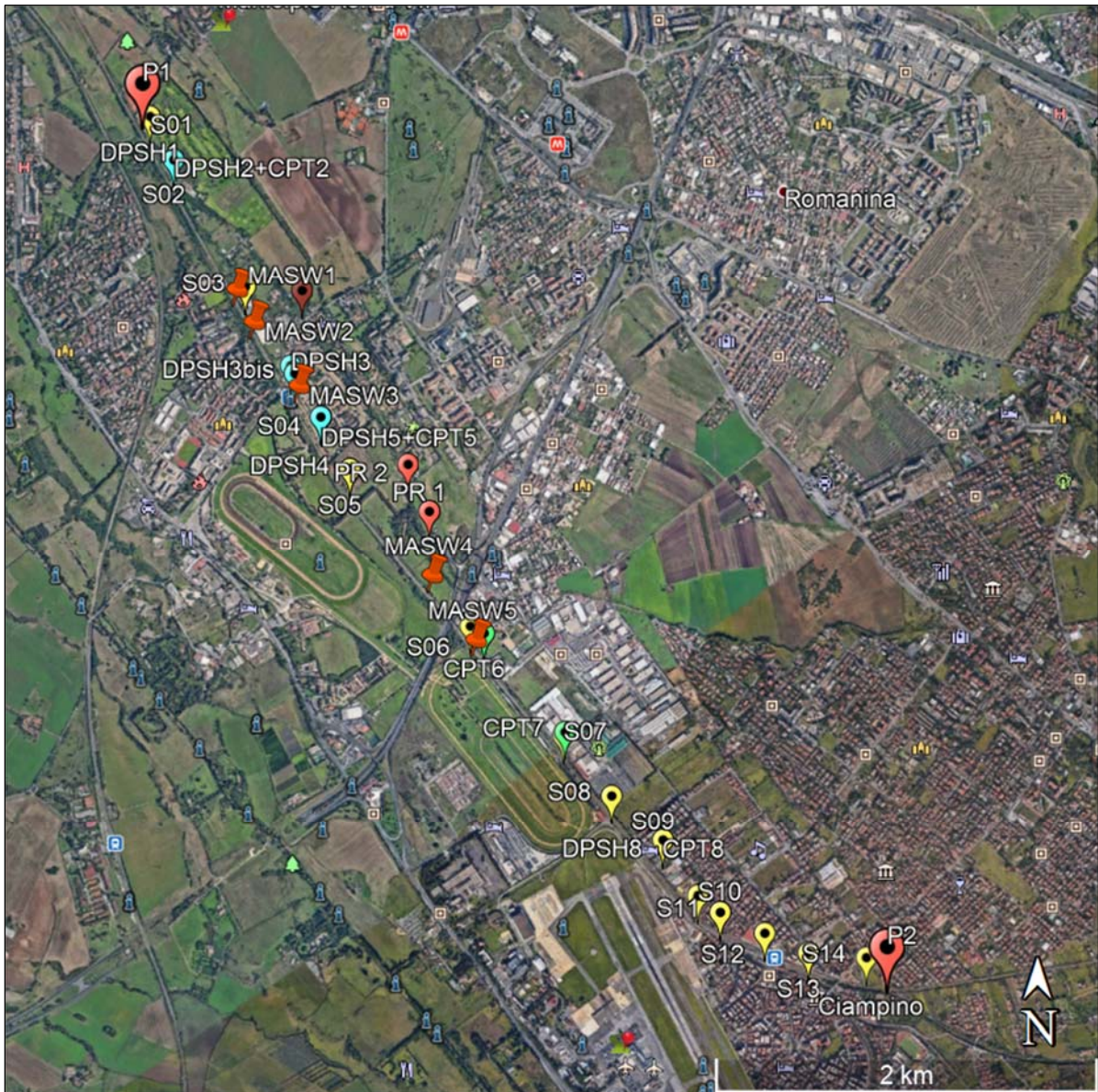
Figura 8-2 – Localizzazione dell'opera di progetto con sondaggi e prove geofisiche eseguite.
