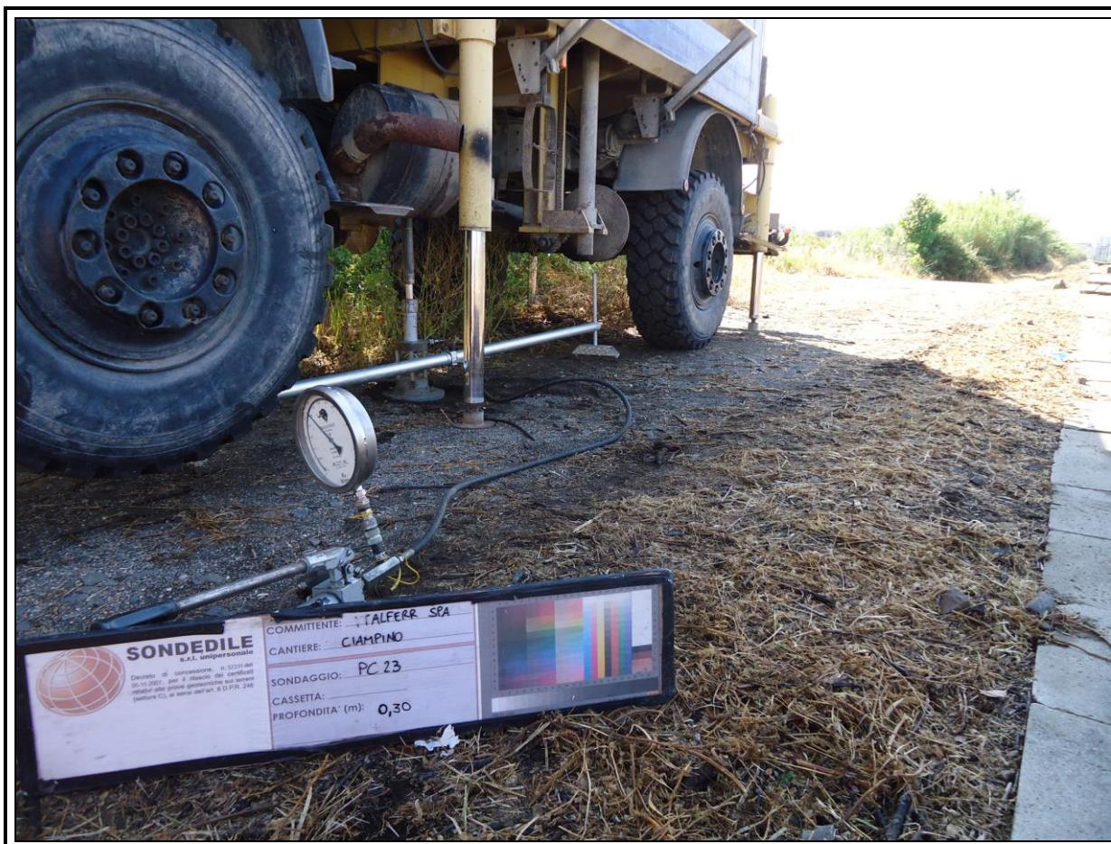
Figura 24 - Postazione prova di carico 23.
