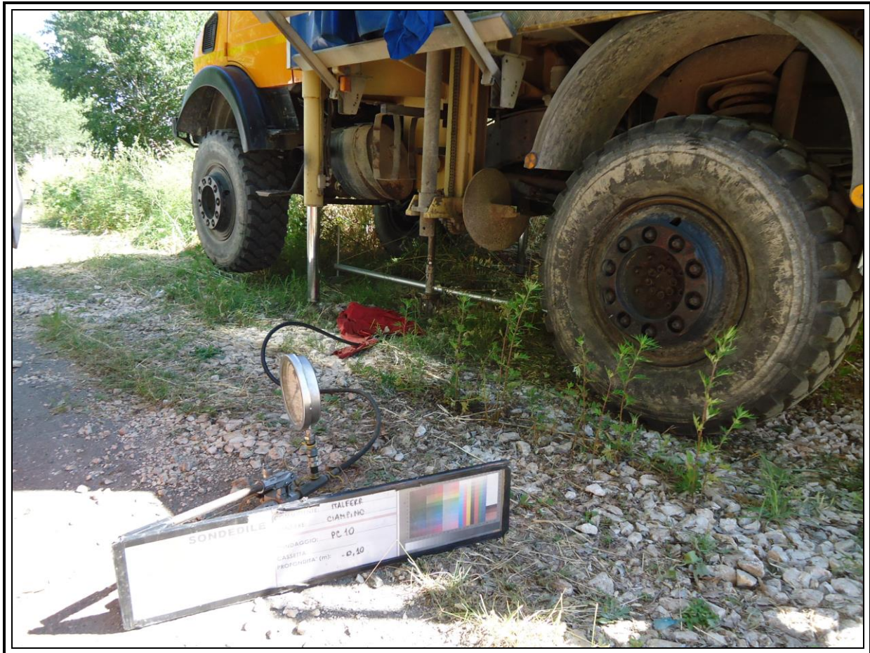
Figura 11 - Postazione prova di carico 10.
