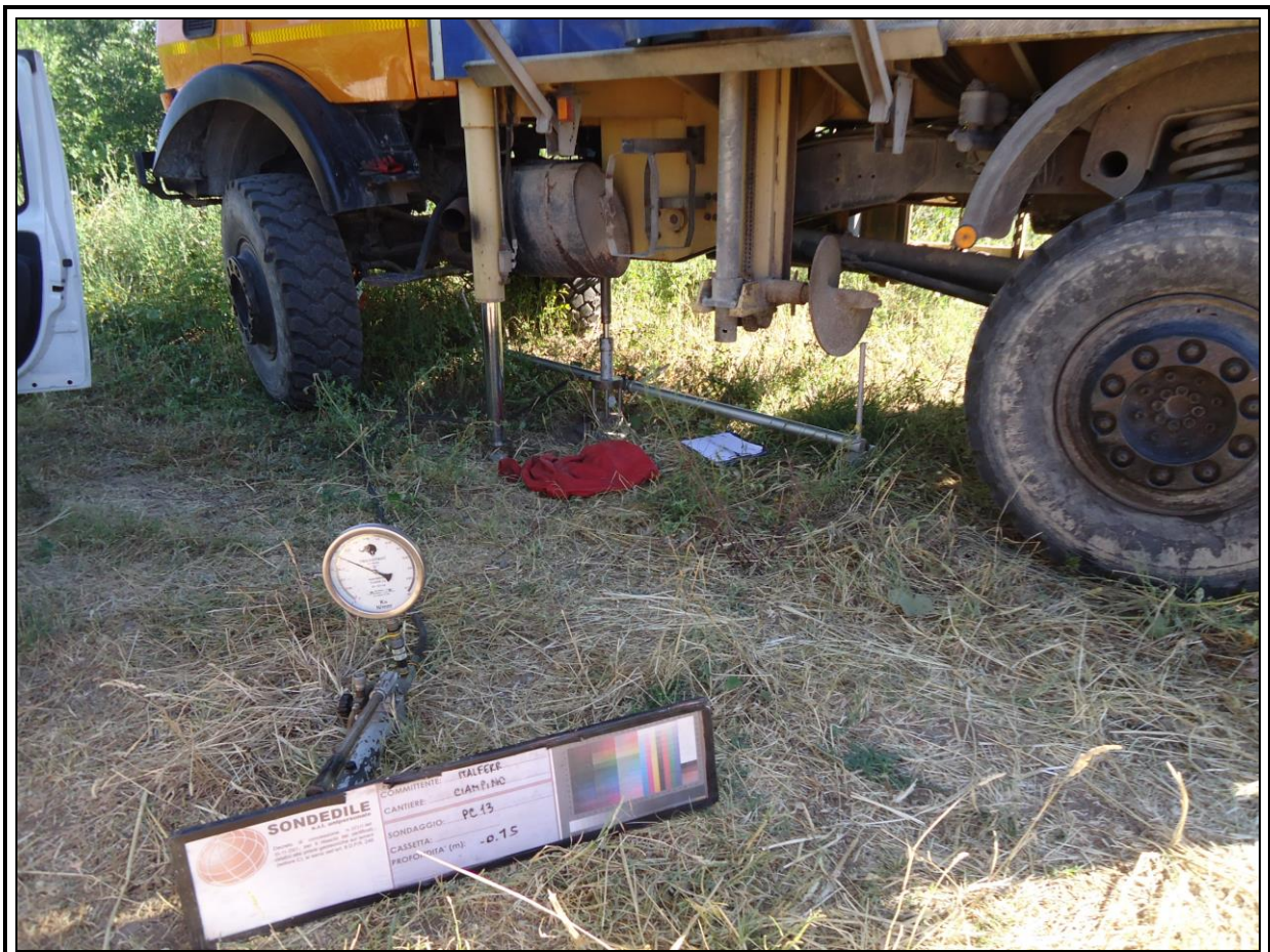
Figura 14 - Postazione prova di carico 13
