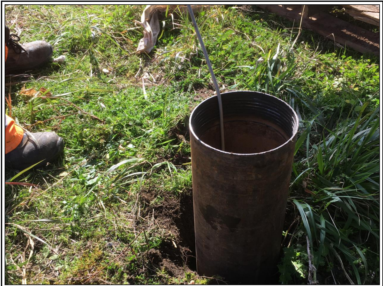
Sondaggio S_10-Rilievo masse metalliche in foro
