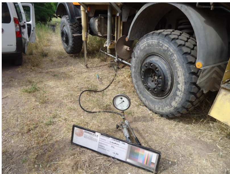
Figura 3 - Prova di carico su piastra.
