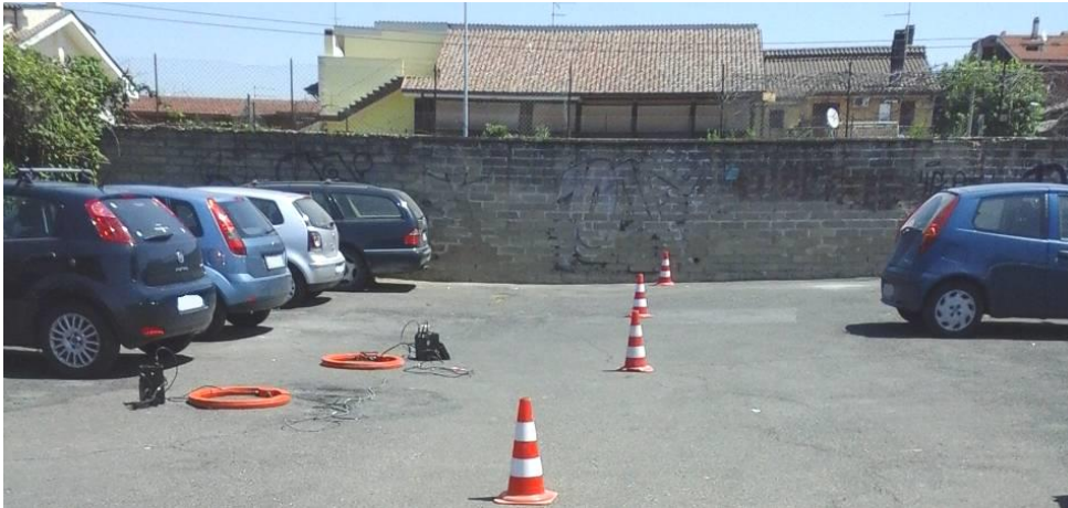
Fasi di esecuzione della prova elettromagnetica con strumento EM34-Geonics, in corrispondenza della piazzola di via Folgarella a Ciampino.
