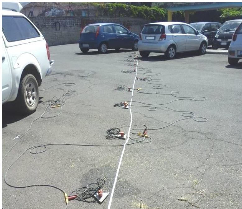
Fasi di esecuzione della prova di sismica attiva MASW, in corrispondenza della piazzola di via Folgarella a Ciampino. Al fine di utilizzare il maggior spazio a disposizione, è stata utilizzata una diagonale utile del parcheggio; per l'accoppiamento con il suolo sono stati utilizzati appositi treppiedi metallici.
