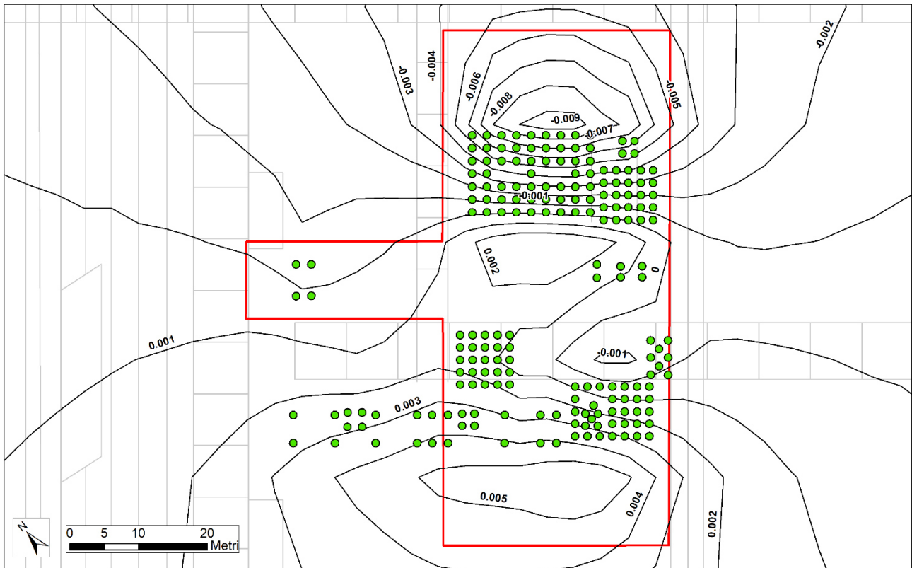
Figura 3-10 Abbassamento (valori positivi) / innalzamento (valori negativi) simulato (in metri) per il layer 2 nell'area BioJet (poligono rosso). I punti verdi indicano le posizioni dei pali
