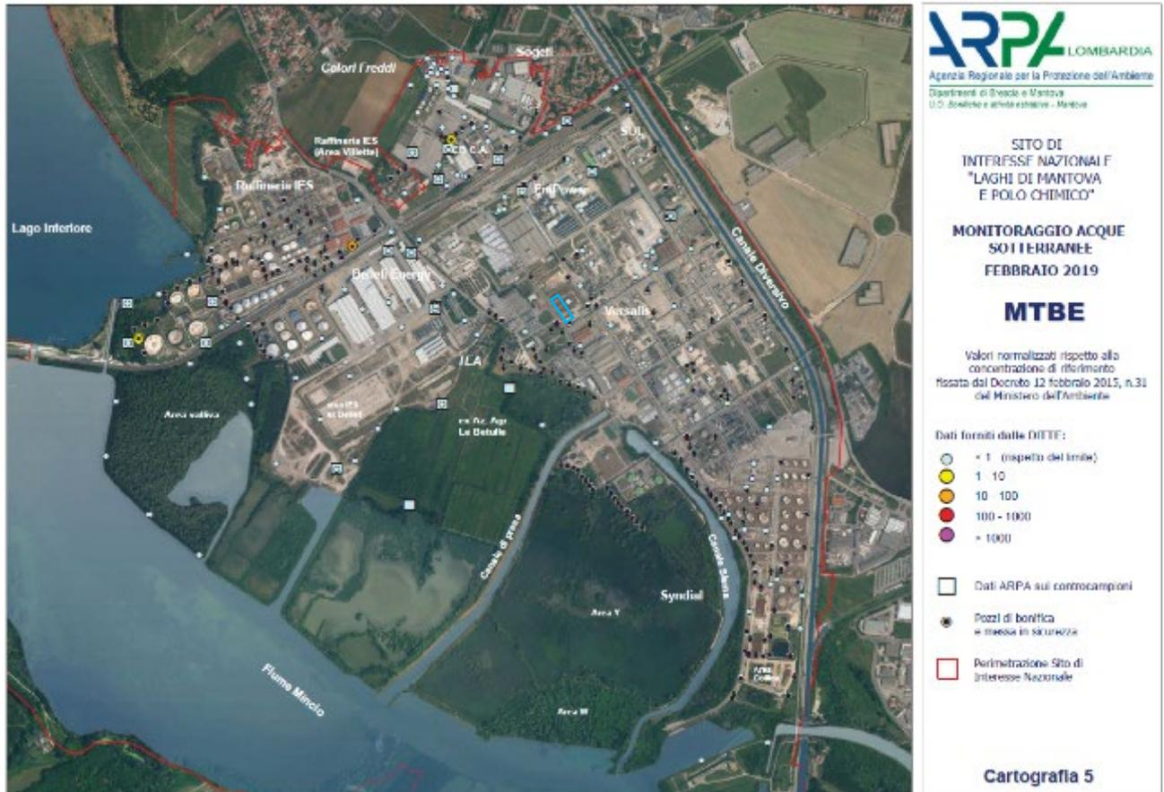
**Figura 5.61 Cartografia delle concentrazioni nelle acque di sotterranee del SIN "Laghi di Mantova e Polo Chimico" – 2019 – MTBE**
