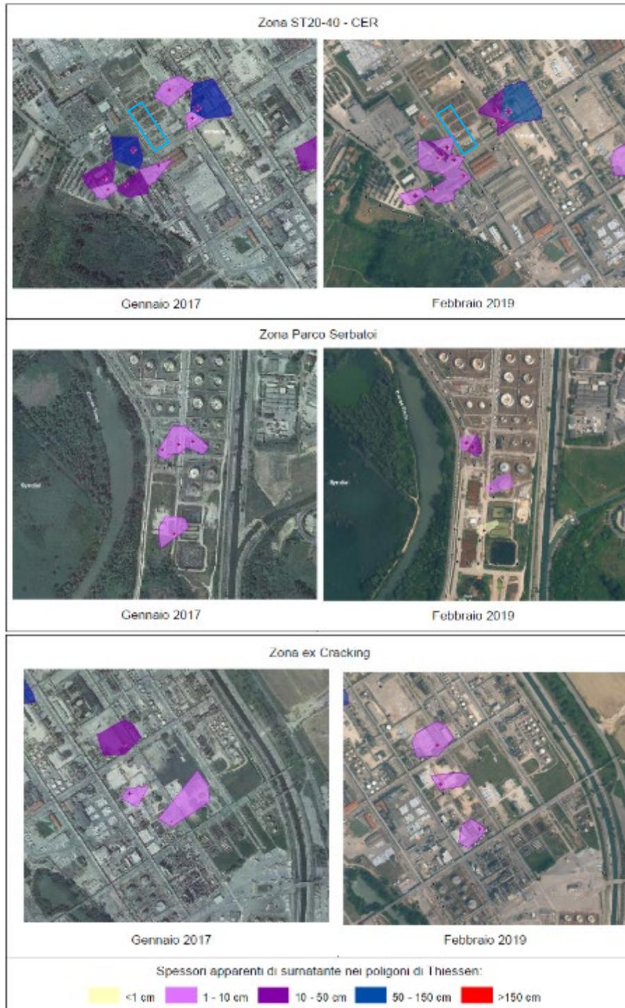
**Figura 5.56 Spessori apparenti di surnatante rilevati nel 2017 e nel 2019 nelle aree di proprietà Versalis (il rettangolo azzurro nella presente figura e in quelle successive, indica l'area di Progetto HOOP)**
