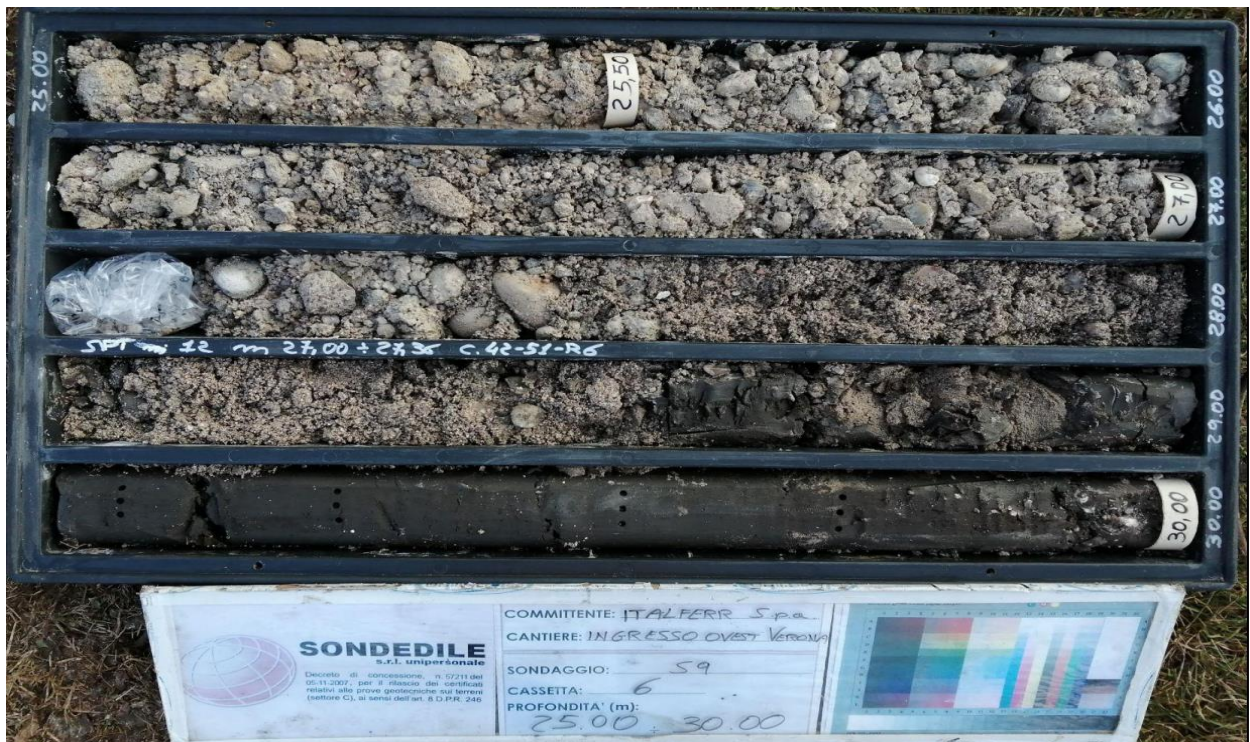
Figura 16. Sondaggio S9, Campagna geognostica ITALFERR 2020-2021, unità Fg R3 , 28.50-30.00 m
