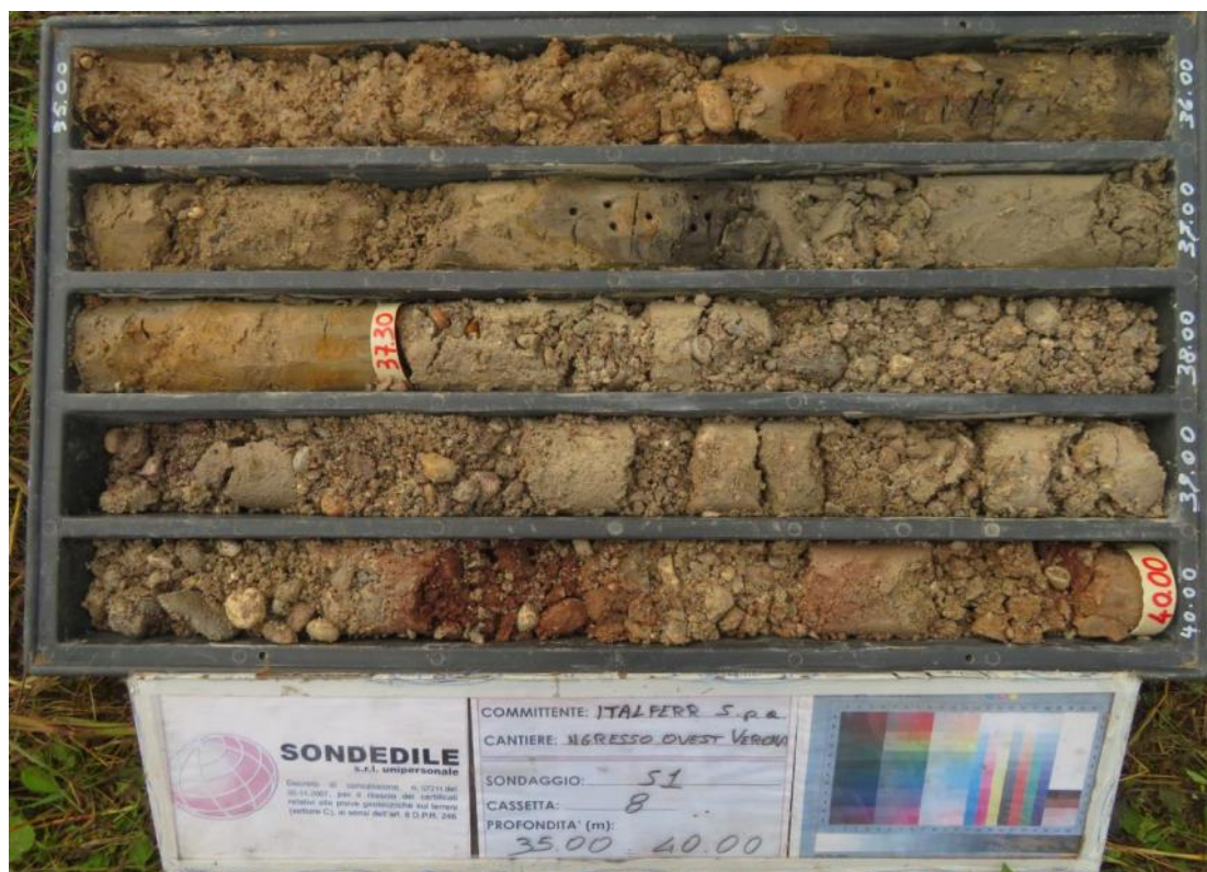
Figura 12. Sondaggio S1, Campagna geognostica ITALFERR 2020-2021, unità Fg R2 , 35.00÷37.20 m
