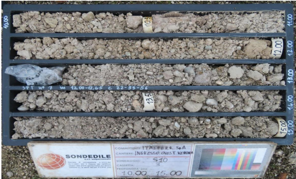
Figura 13. Sondaggio S10, Campagna geognostica ITALFERR 2020-2021, unità Fg R31 , 10.00-15.00 m
