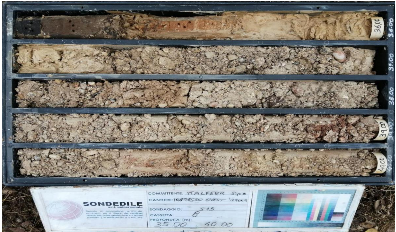
Figura 15. Sondaggio S15, Campagna geognostica ITALFERR 2020-2021, unità Fg R3 , 35.30-36.30 m
