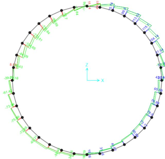
**Figura - 29 SOLETTA SLU – V2 max./min.**
