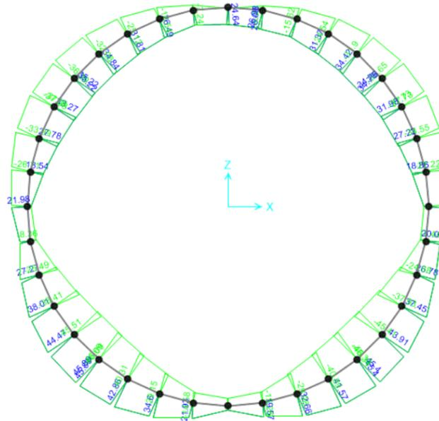
**Figura - 31 SOLETTA SLV -M3 max./min.**
