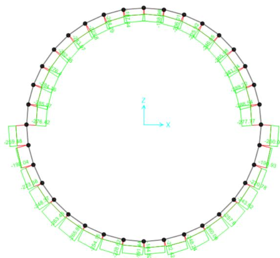
**Figura - 30 SOLETTA SLV – AXIAL max./min.**
