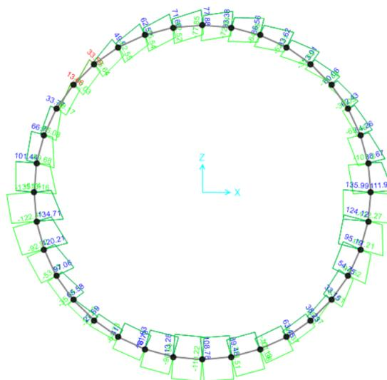
**Figura - 32 SOLETTA SLV -V2 max./min.**
