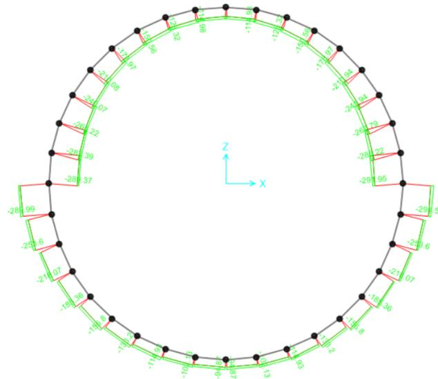
Figura - 27 SOLETTA SLU – AXIAL max./min.
