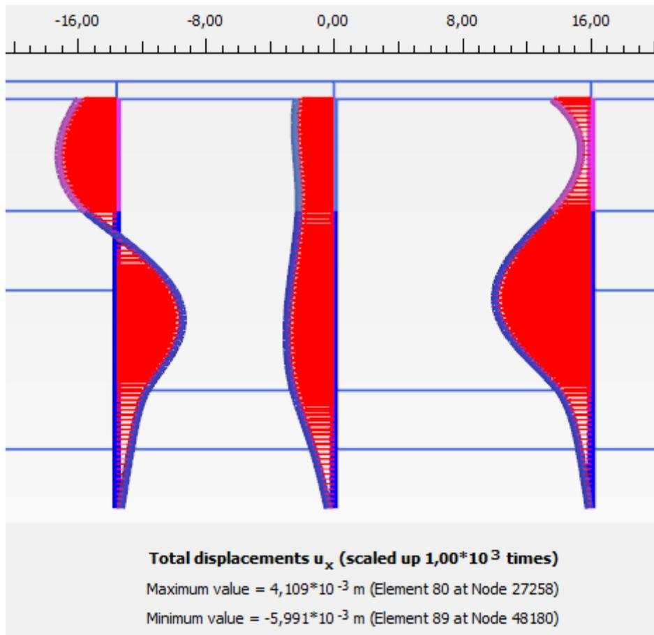
Figura 11 – Involuppo della deformata dell'opera (SLU) nei vari step di calcolo
