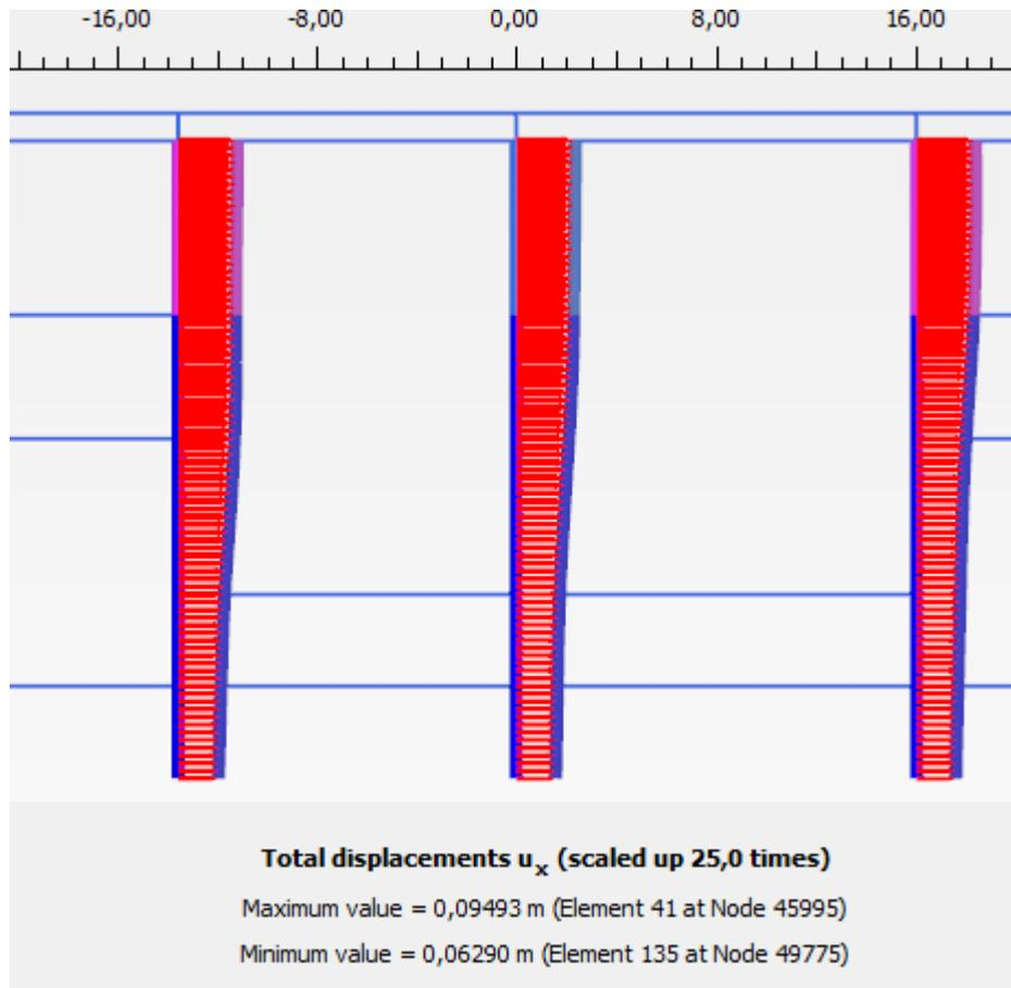
Figura 13 – Involuppo della deformata dell'opera (SLV(-)) nei vari step di calcolo
