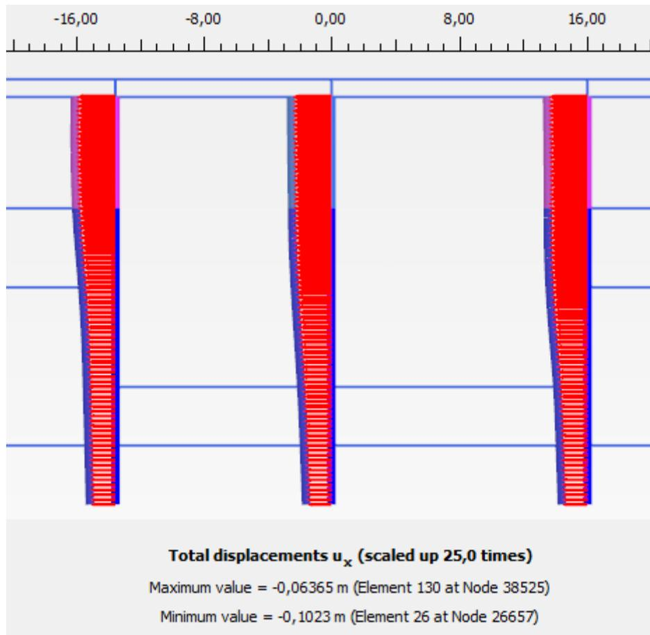
Figura 12 – Inviluppo della deformata dell'opera (SLV(+)) nei vari step di calcolo
