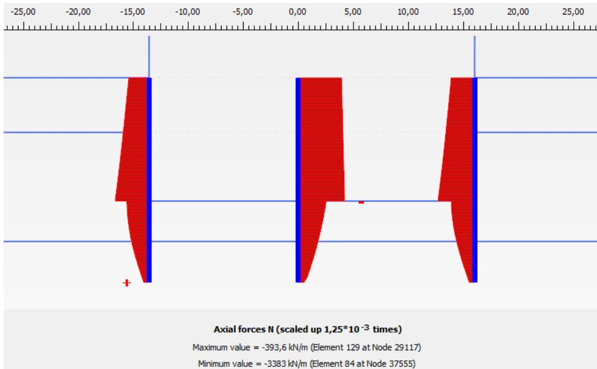
*Figura 19: Sforzo normale statico agente nei pali (SLU)*
