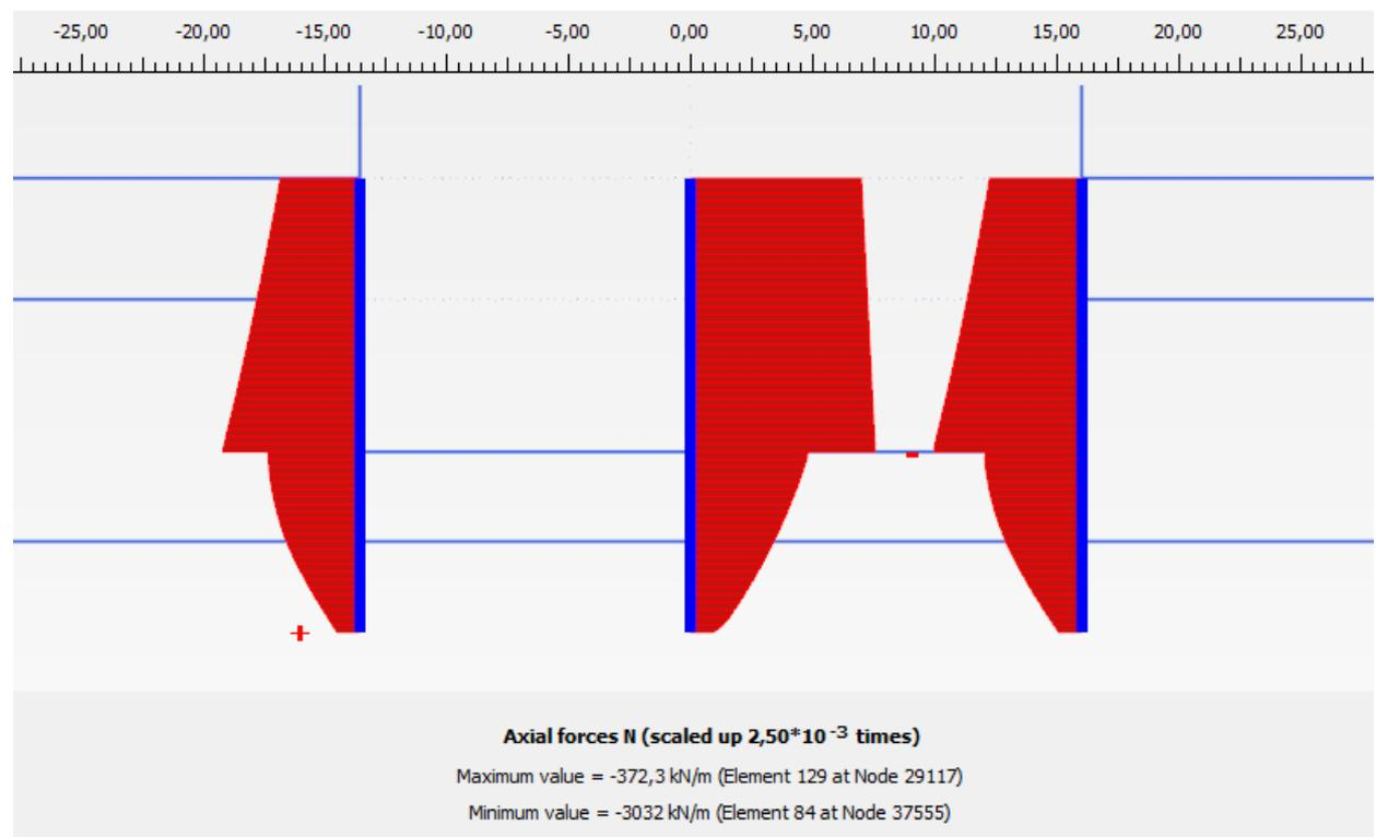
*Figura 16: Sforzo normale statico agente nei pali (SLE)*
