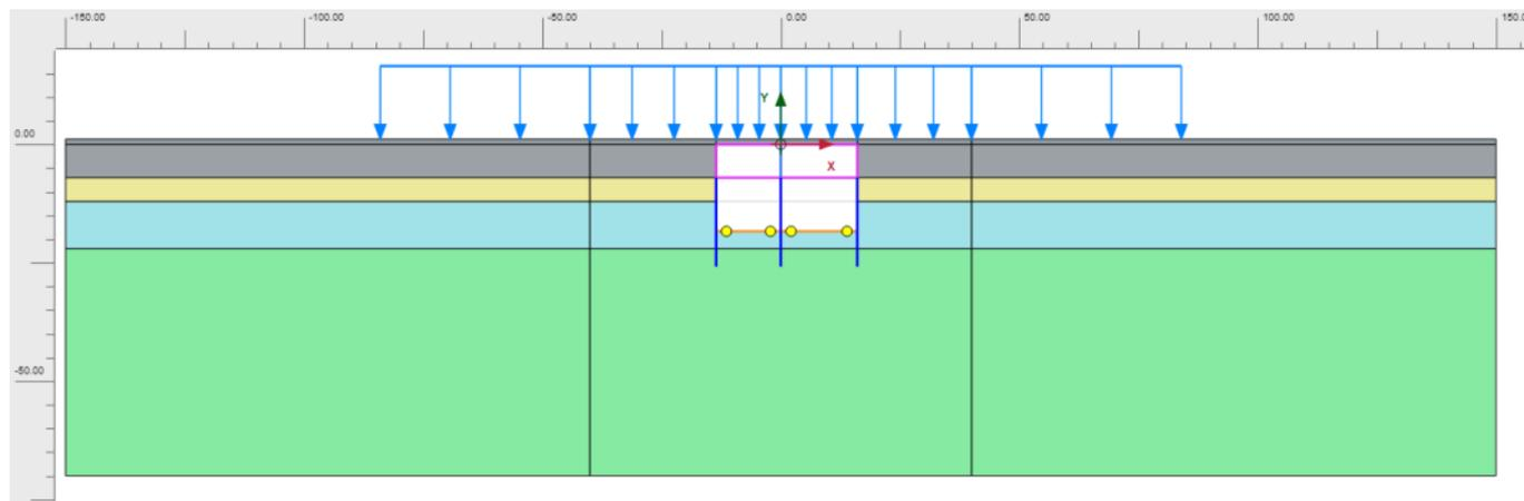
**Figura 10 – Modello di calcolo: geometria, stratigrafia e carichi applicati**
