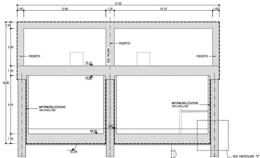
Figura 7 - Sezione Del Metodo Milano Box – Tratto a Singola Fornice (Parte nord)
