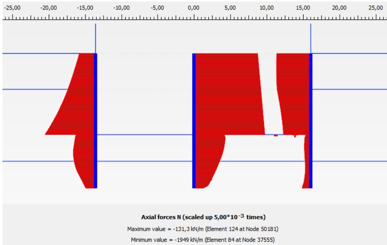
Figura 25: Sforzo normale statico agente nei pali (SLV-)
