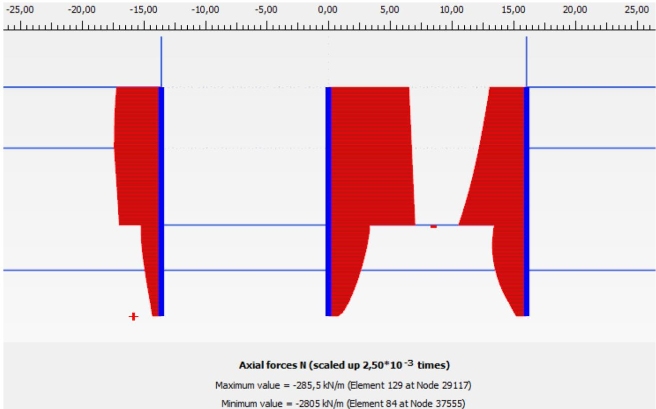
Figura 22: Sforzo normale statico agente nei pali (SLV+)
