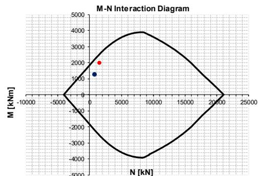
Le verifiche strutturali sono pertanto tutte soddisfatte. Per la sezione in esame l'incidenza è di 185 kg/m<sup>3</sup>.
