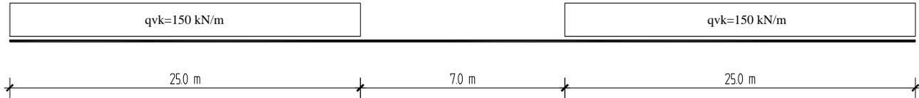
Figura 6.3 Distribuzione uniforme del treno di carico SW2
