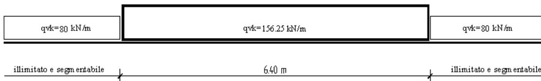
Figura 6.2 Distribuzione uniforme del treno di carico LM71
