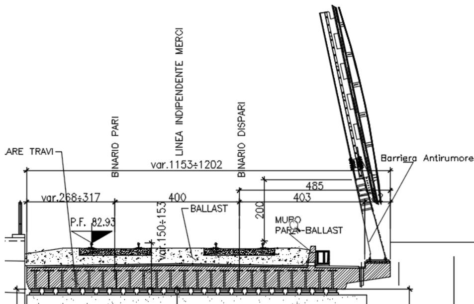
Si prevede di impiegare 23 profili HEM700 ad interasse di 44cm. Il numero di travi comprese in una fascia di 4.00m, considerata reagente nelle verifiche di resistenza, è pari a 9. Lo spessore dell'impalcato è di 80cm.
