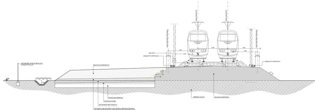
FASE 2: COMPLETAMENTO DEL RILEVATO E REALIZZAZIONE ARMAMENTO DEL BINARIO DI PROGETTO
