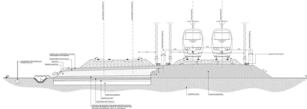
FASE 3: DEMOLIZIONE DEL BINARIO ESISTENTE E RIMOZIONE PARZIALE DEL RILEVATO
