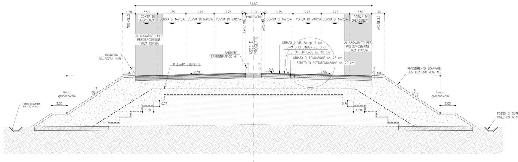
**SEZIONE TIPO IN RILEVATO**
