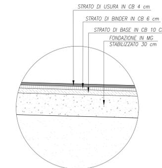
**SEZIONE TIPO IN RILEVATO H<5 m**
