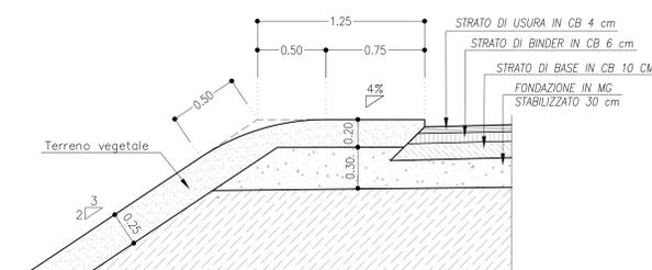
**SEZIONE TIPO IN RILEVATO H>5 m**
