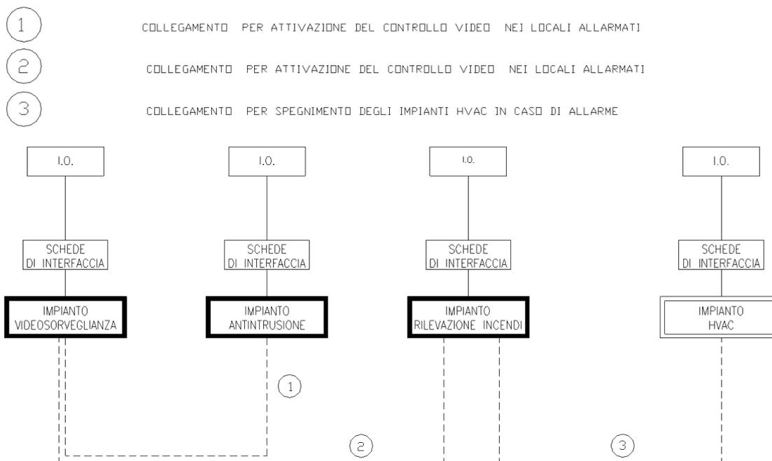
Trascorso un prefissato tempo (configurabile) senza che sia stato disattivato l'allarme proveniente dal sistema antintrusione o rivelazione incendi, la segnalazione di allarme stessa sarà trasmessa al sistema di supervisione.
