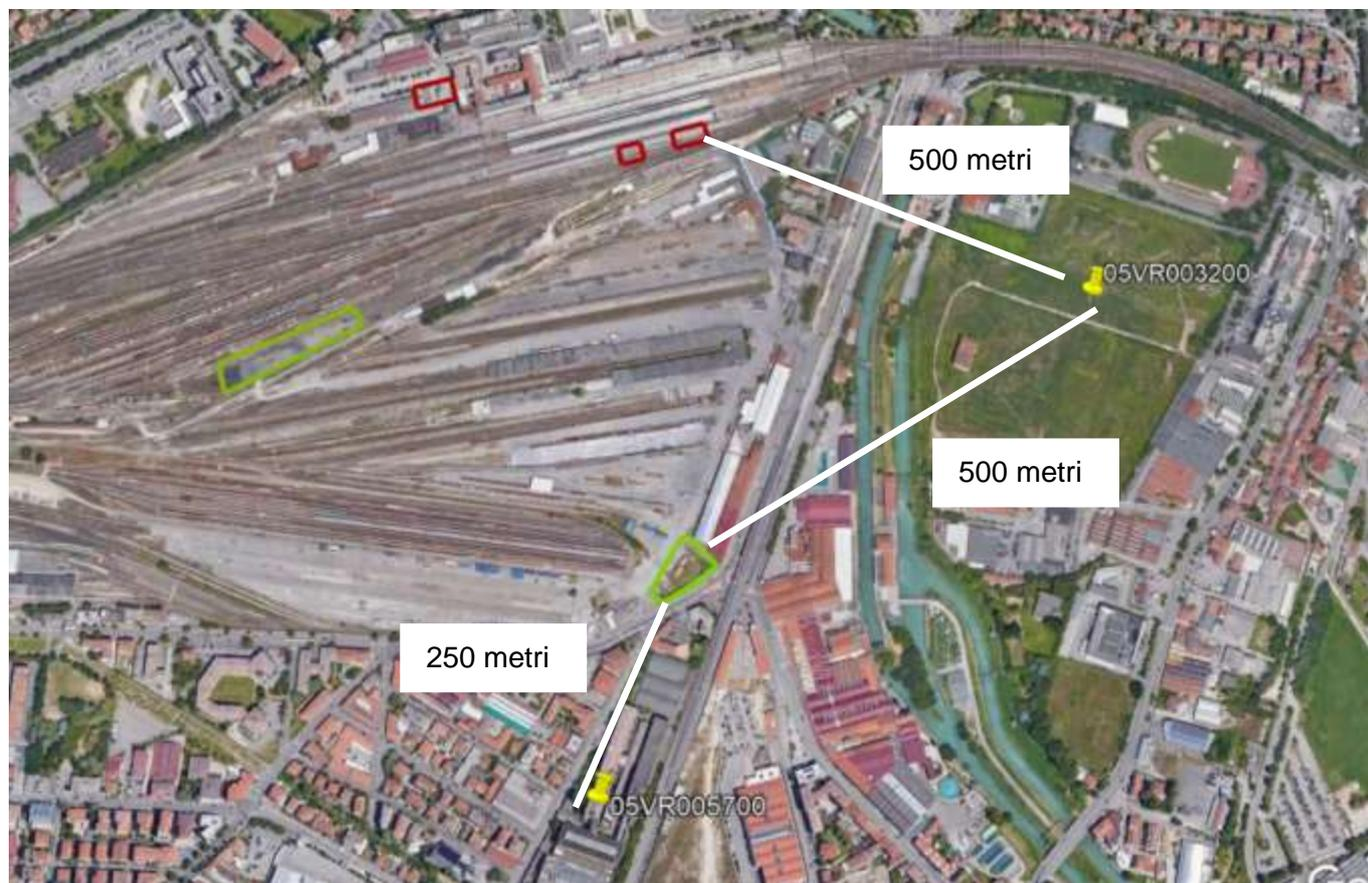
Figura 4.26 - Localizzazione delle aree di cantiere rispetto ai siti contaminati censiti nell'anagrafe regionale ubicati ad una distanza inferiore di 500 metri
