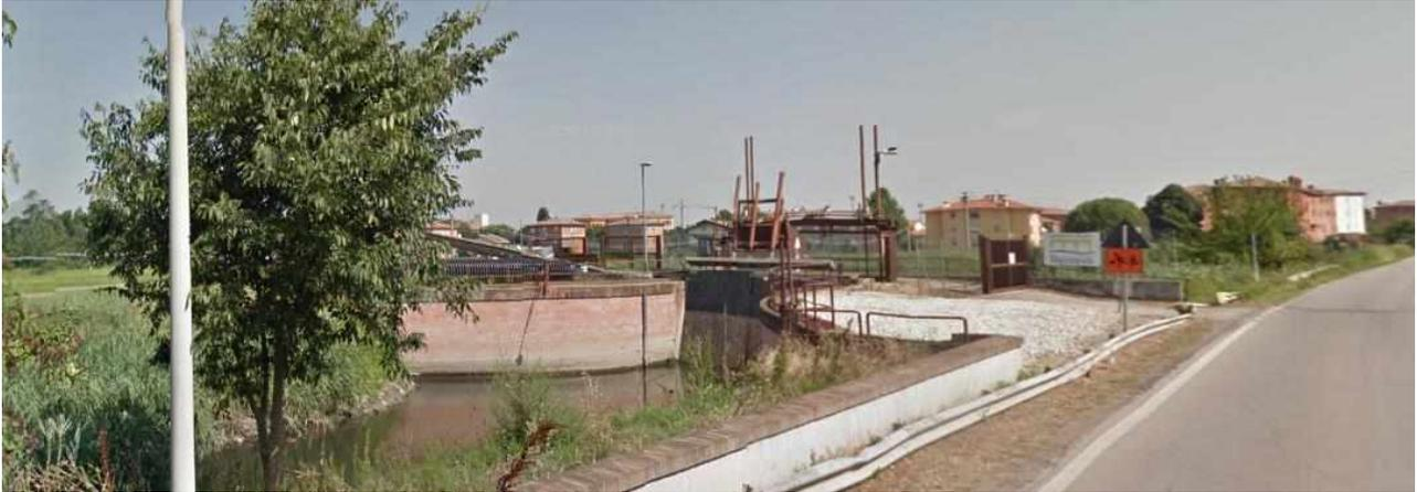
*Figura 34: Paratoie sul canale Navile necessarie per deviare al portata sul Canale Diversivo*
