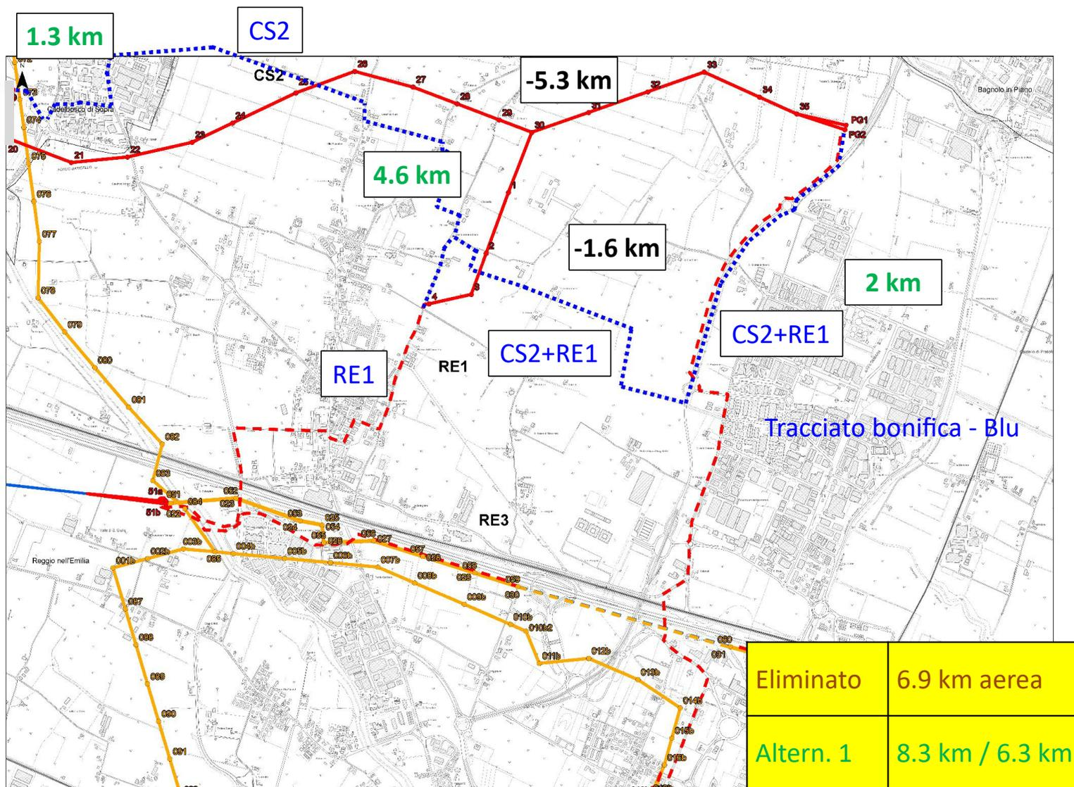
Figura 6 – Tracciato alternativo secondo canale di bonifica esistente per le tratte CS2 ed RE 1 (linea blu tratteggiata), con riferimento alla planimetria di progetto
