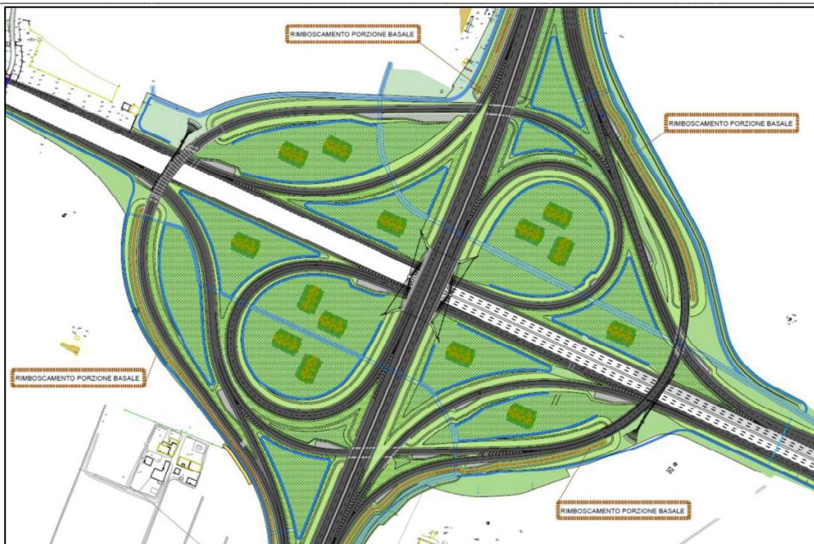
Figura 13 - Interventi di rimboscimento presso lo svincolo A22-A4
