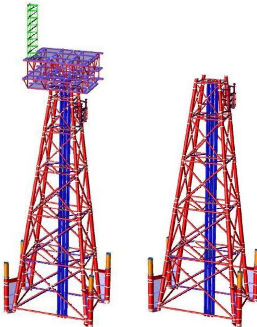
Fig 24 Modello strutturale Piattaforma e Jacket 4 gambe
