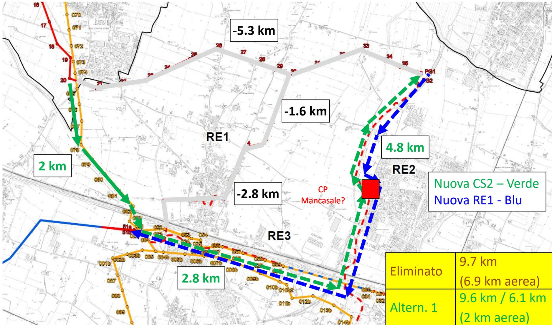
Figura 4 – Tracciato alternativo per le tratte CS2 (linea verde) ed RE 1 (linea blu), con riferimento alla planimetria di progetto (tratta da elaborato Terna DU0000006B1937737)
