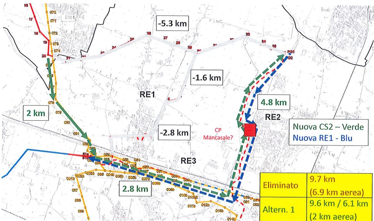
Figura 4 – Tracciato alternativo per le tratte CS2 (linea verde) ed RE 1 (linea blu), con riferimento alla planimetria di progetto (tratta da elaborato Terna DU0000006B1937737)
