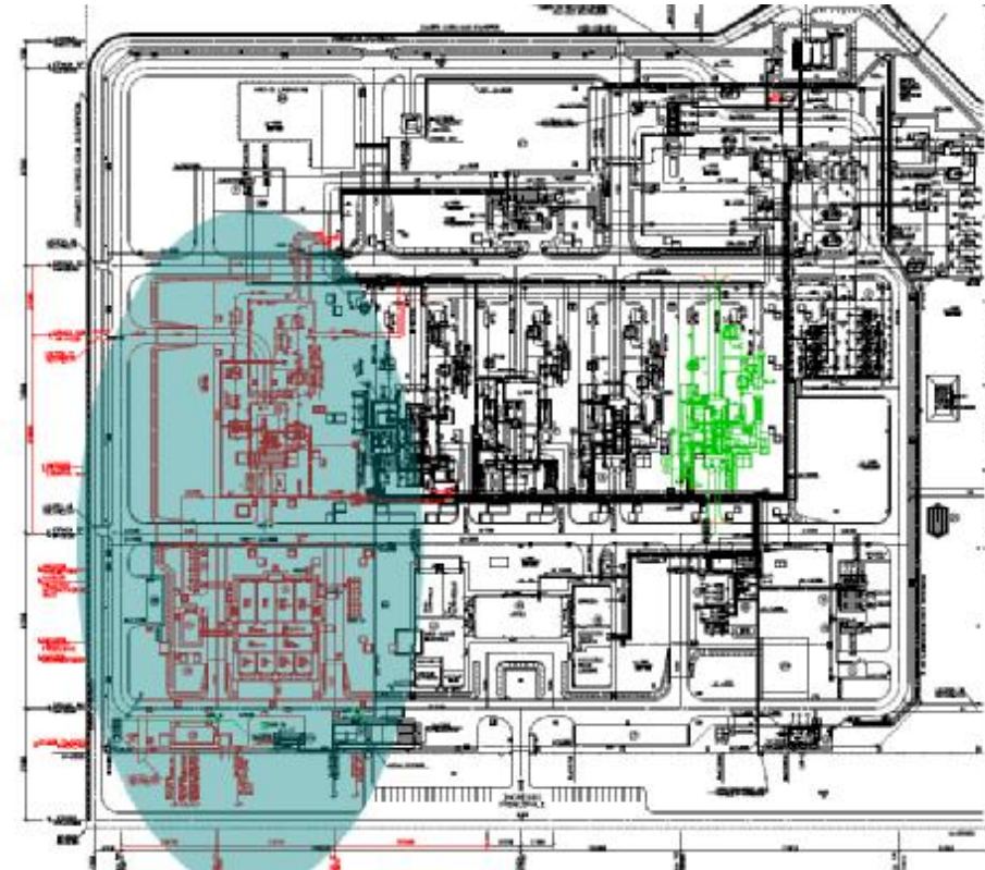
Figura 6-30 – Individuazione dei punti di indagine (a sinistra) e ubicazione aree di intervento (a destra: in verde sono evidenziate le demolizioni, mentre in rosso le nuove realizzazioni)
