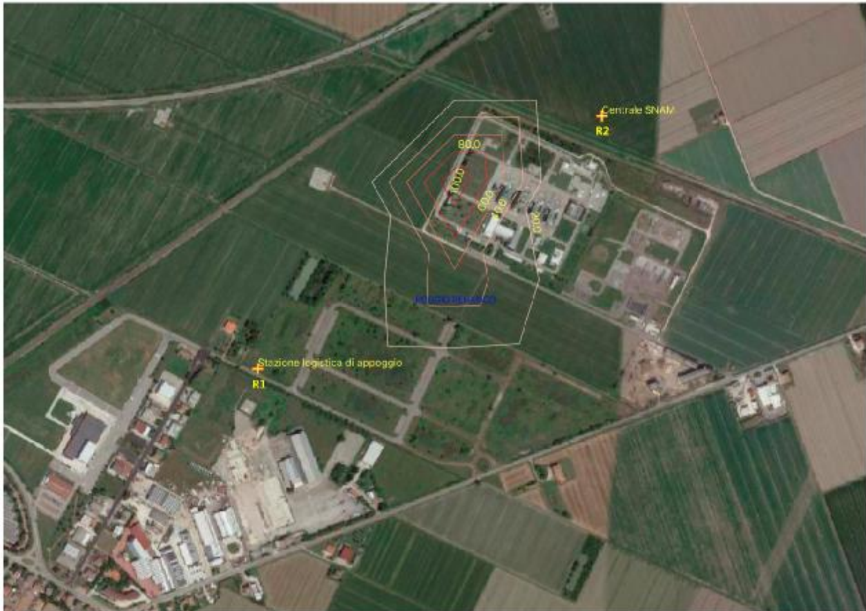
Figura 8-13 – Concentrazione di NOx al suolo espresso come media maggiore di 20 ug/mc, per il periodo di massima emissione (11° mese dall’inizio delle attività) associate al cantiere della Centrale di Compressione SNAM
