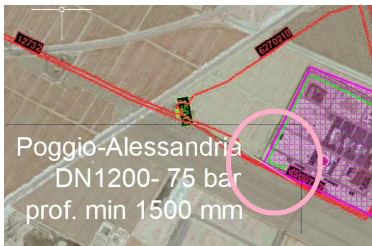
Fig. 9. Parallelismo No.2 fra il cavidotto MT (in verde) e i metanodotti (in rosso).
