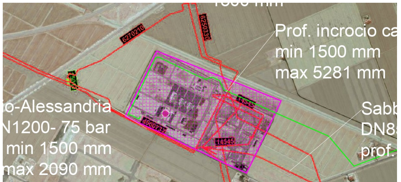
Fig. 6. Layout del cavidotto MT e le tubazioni gas esistenti.
