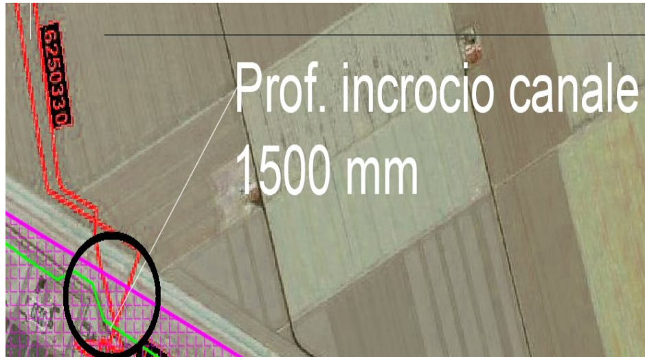
Fig. 7. Incrocio fra il cavidotto MT (in verde) e i metanodotti (in rosso).
