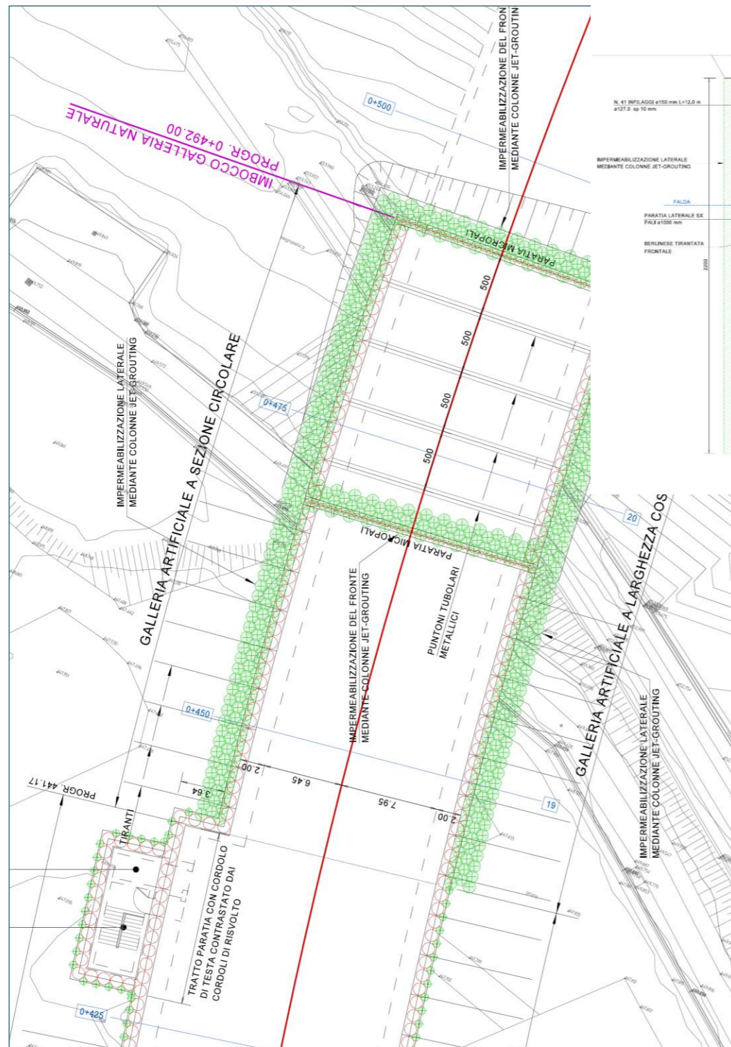
Figura 18 – Galleria naturale – Stralcio planimetrico imbocco Sud
