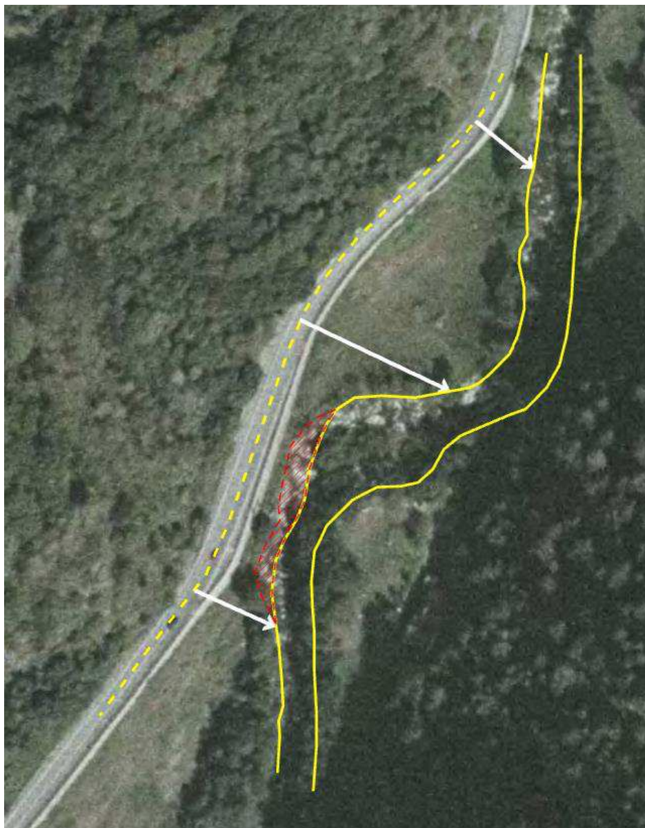
Figura 13: Episodio di erosione spondale in destra, sostanzialmente identico a quello del 2018 (condizione attuale).
