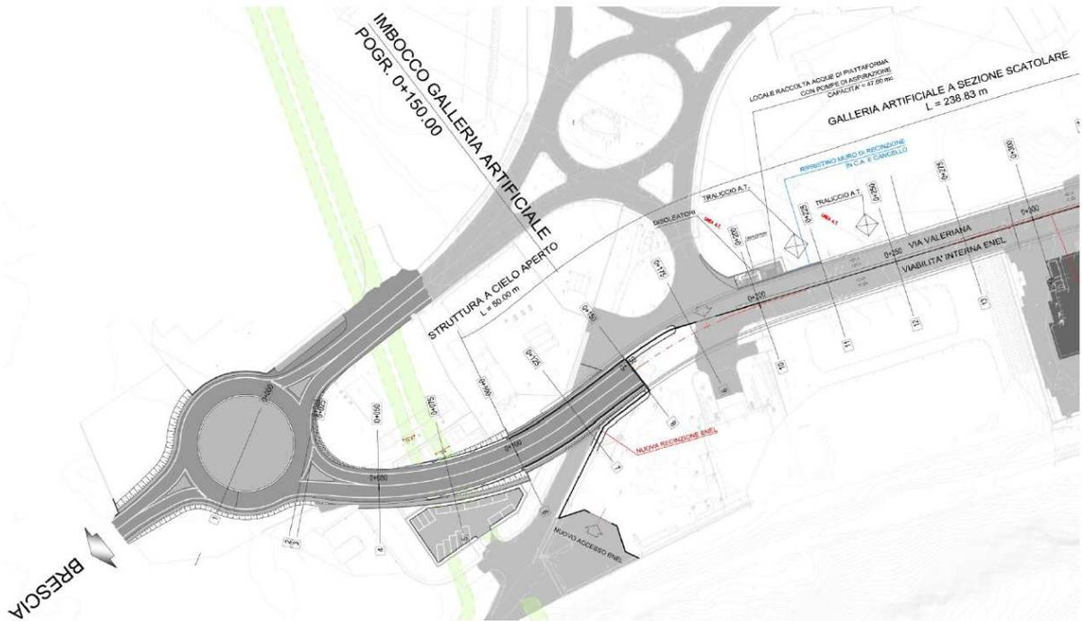
**Figura 3 – Schema planimetrico Rotatoria Sud -**
