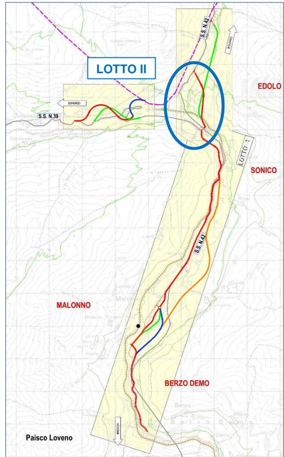
Nella Progettazione Preliminare, con riferimento alle “Norme funzionali e geometriche per la costruzione delle strade (DM 5/11/2001)” veniva adottata una piattaforma stradale relativa ad una strada extraurbana secondaria di Tipo “C2”. Attualmente è stata ritenuta necessaria e migliorativa l'adozione delle caratteristiche progettuali di una strada extraurbana di Tipo “C1”.
