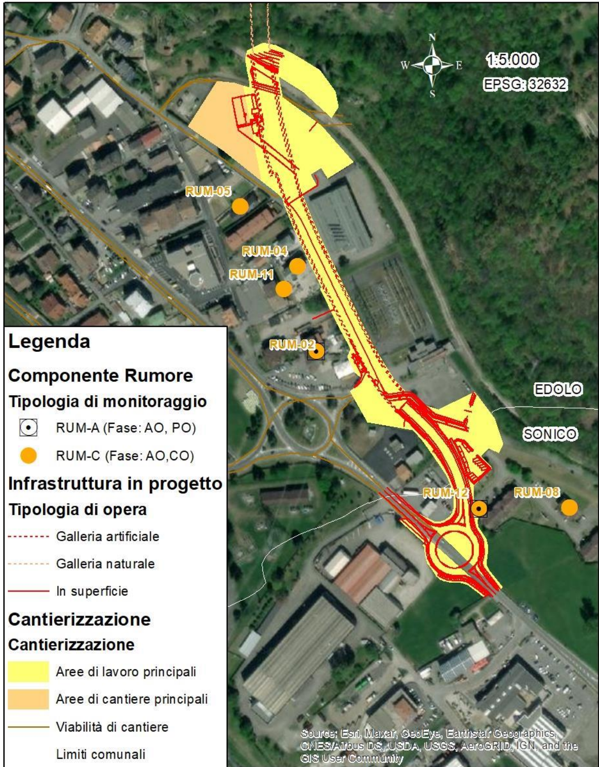
Figura 20 - Planimetria localizzazione indicativa postazioni di monitoraggio della componente Rumore – Cantiere Operativo Sud
