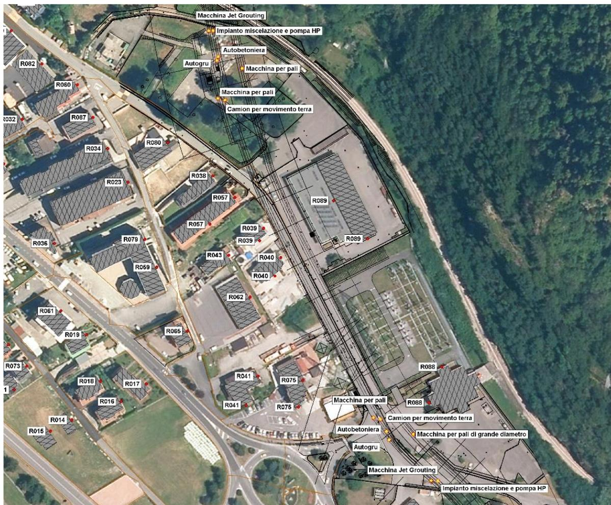
**Figura 6.5 – Variante Est Edolo – Ubicazione dei macchinari sull’area di cantiere per la simulazione dell’attività cantieristica A.**
