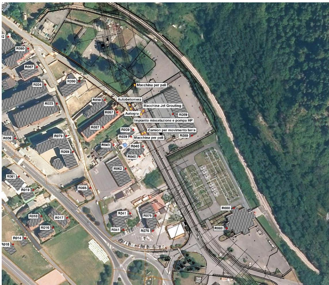
**Figura 6.7 – Variante Est Edolo – Ubicazione dei macchinari sull’area di cantiere per la simulazione dell’attività cantieristica C.**
