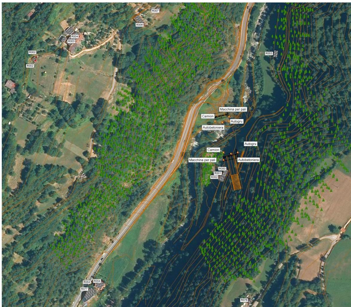
**Figura 6.8 – Variante Est Edolo – Ubicazione dei macchinari sull’area di cantiere per la simulazione della attività cantieristica C**
