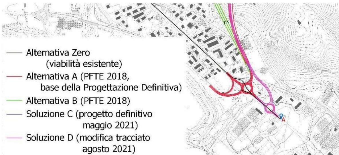
**Figura 3.3.2 – dettaglio della planimetria delle quattro soluzioni alternative di progetto allo svincolo Sud**
